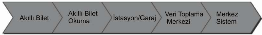
Şekil 2: Otomatik Ücret Toplama Sisteminde Veri Akışı
