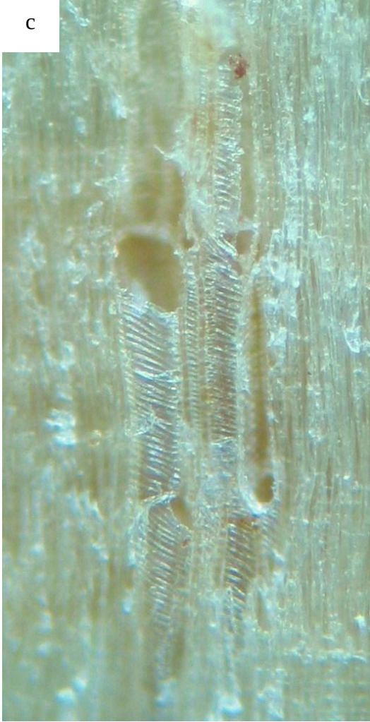
Şekil 3.33 Pistacia terebinthus L. Kontrol Grubu a,b,c,d. Radyal yüzeyde helikal kalınlaşmalar, basit perforasyon tablaları.
