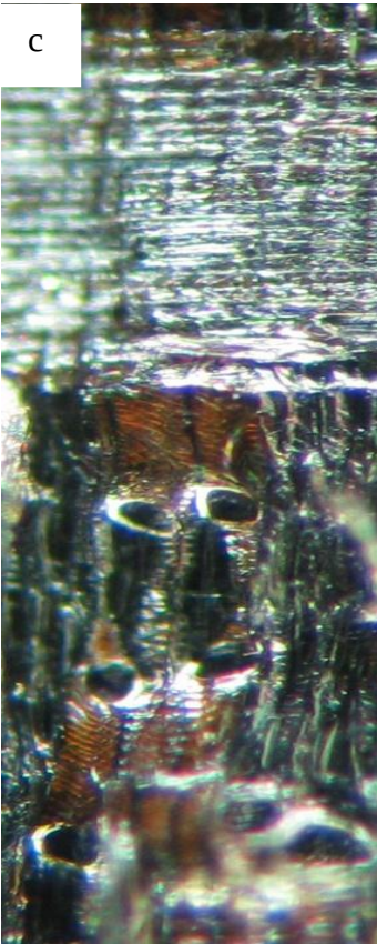
Şekil 3.36 Pistacia terebinthus L. Kömürleşmiş Grup a,b Helikal kalınlaşmalar, c. Radyal yüzeyde özışını, trahelerdeki basit perforasyon tablaları, d. Teğet yüzeyde tülle dolmuş trahe.
