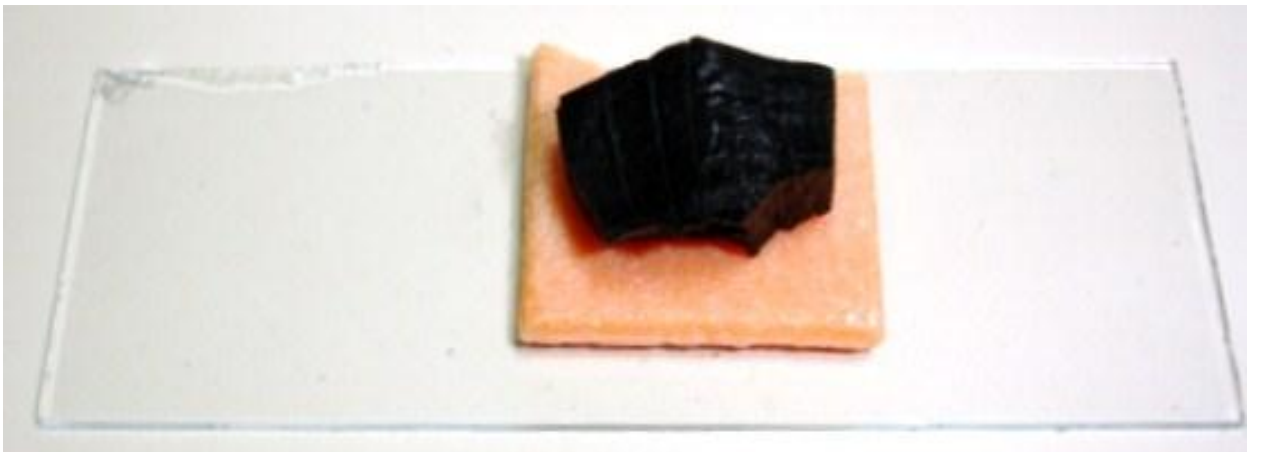
Şekil 2.2 Lam üzerine yerleştirilen karbonlaşmış odun örneği.
