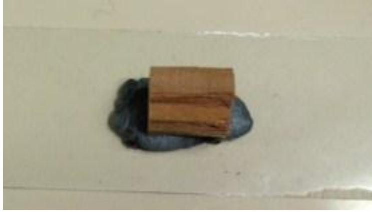
Şekil 2.4 Radyal yüzeyin fotoğraf çekimi için lama yerleştirilen kontrol örnek.
