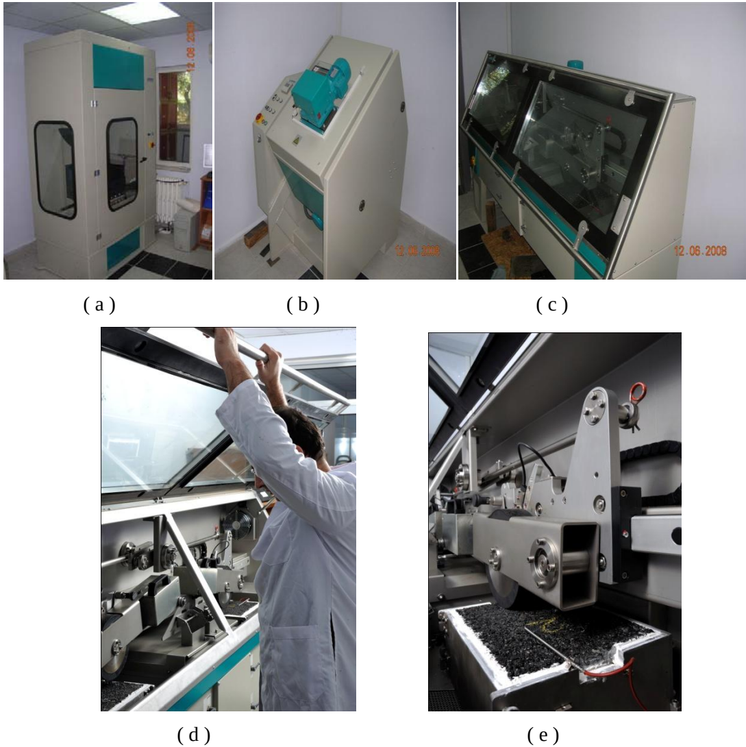
Şekil 3.41: Tekerlek izi test cihazı, (a) Karışım üretim, (b) Karışım sıkıştırma, (c, d, e) Tekerlek izi cihazı ekipmanları.
