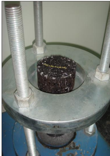
Şekil 3.23: Briket numunelerinin kalıptan çıkartılarak laboratuvar ortamında bekletilmesi.
