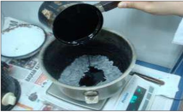
Şekil 3.21: Agregas numunesi ve bitümlü bağlayıcının karıştırılması
