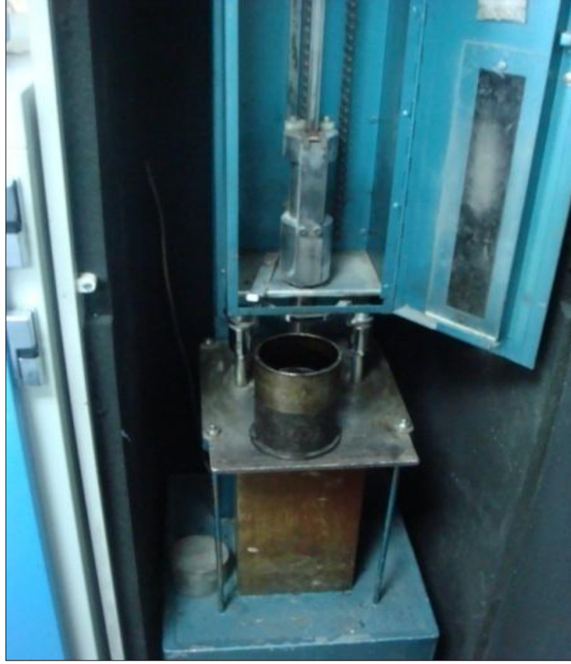
Şekil 3.22: Marshall tokmağında briketlerin hazırlanması.
