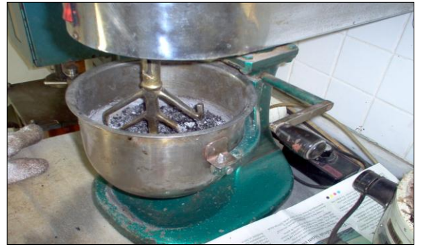
Şekil 3.21: Agregas numunesi ve bitümlü bağlayıcının karıştırılması
