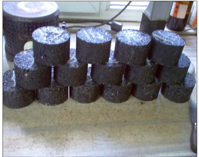
Şekil 3.23: Briket numunelerinin kalıptan çıkartılarak laboratuvar ortamında bekletilmesi.
