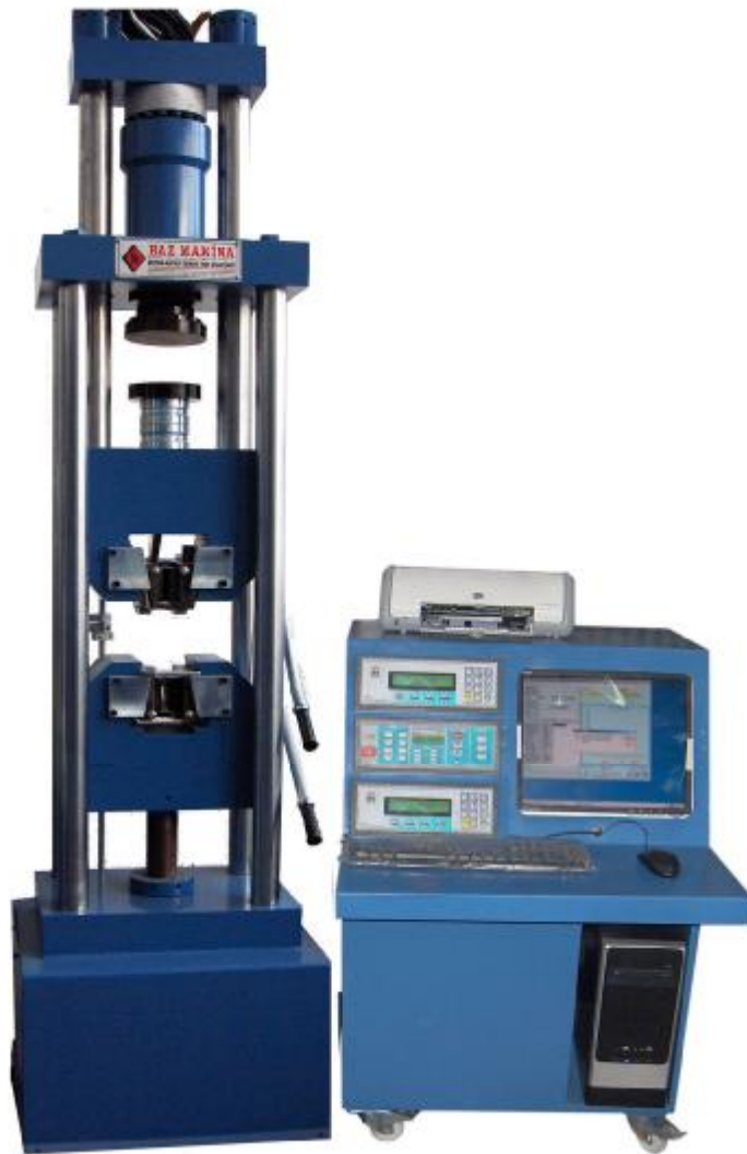
Şekil 3.15. Baz Makine markalı BT-001/60 DÇ 60 ton kapasiteli hidrolik test makinesi.
