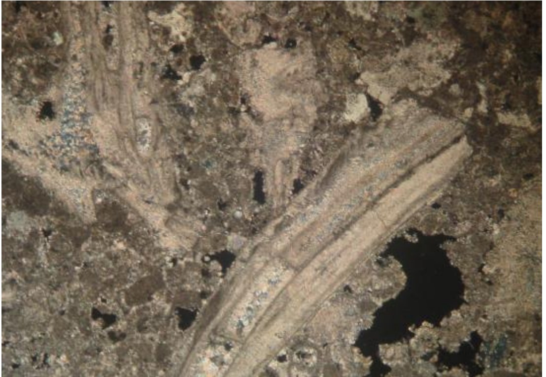
Şekil 4.10. Fosilli Biyomikritte Lamellibrans kavkı kesiti ve gözenek alanları, P.I., 40x.
