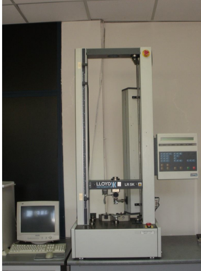
Şekil 3.6. Sıkıştırma testlerinde kullanılan mekanik test cihazı (Llyod Instruments LK-5K, İngiltere)
