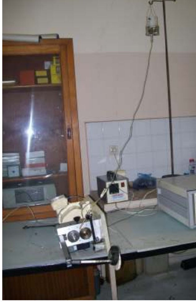
Resim 5. b) Abrasiv takviyeli yağlı koşullardaki deney düzeneği.
