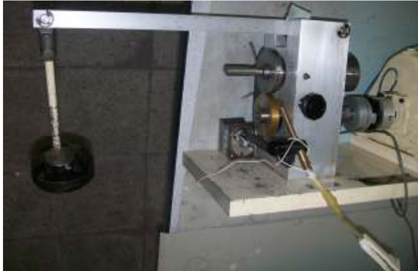
Resim 5. a) Abrasiv takviyeli yağlı koşullardaki deney düzeneği.
