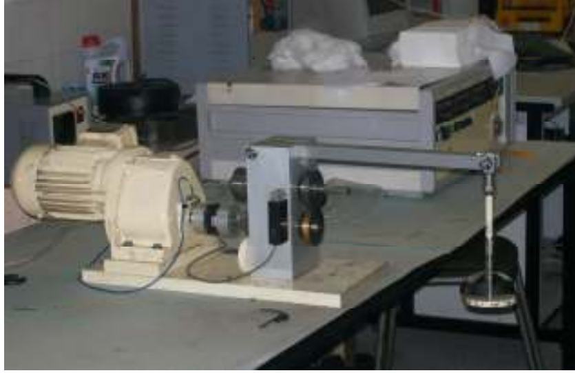
Resim 4. Aşınma deney düzeneğinin kuru koşullardaki genel görünümü.
