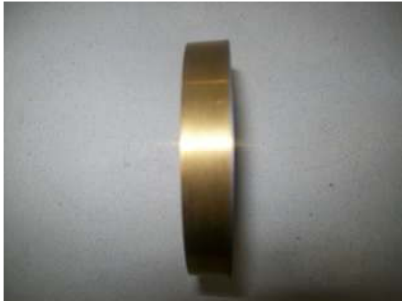
Resim 1. Aşındırıcı (TiN kaplı) disk.
