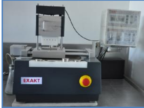
Şekil 3.9: Hassas Aşındırma Ünitesi
