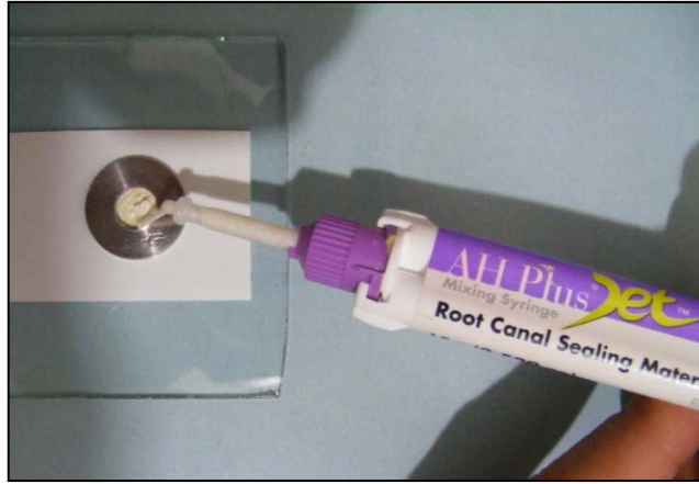
Şekil 8: AH Plus Jet patının kalıba yerleştirilmesi
