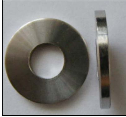
Şekil 1: Çalışmamızda kullandığımız dış çapı 20 mm, iç delik çapı 8 mm olan, 2 mm kalınlığındaki paslanmaz çelik kalıplar
