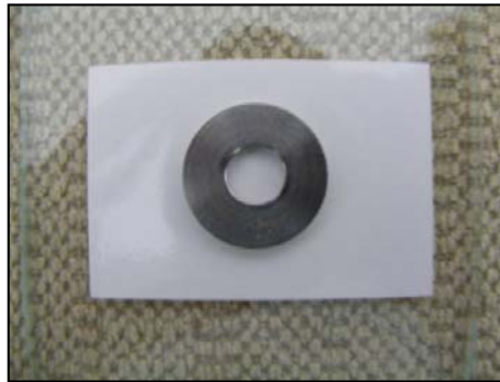
Şekil 3: Siman camına yerleştirilmiş alt yüzeyi asetat kağıdı ile kaplı kalıplar
