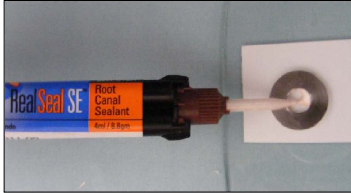
Şekil 10: Real Seal SE patının kalıba yerleştirilmesi
