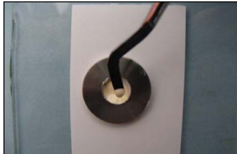
Şekil 19: Acroseal patının kalıplara yerleştirilmesi
