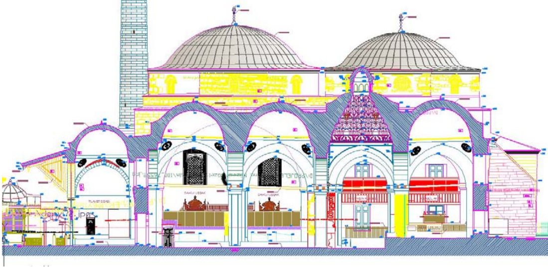
Şekil 3.18 Kesit görünüşlerden kemer kotlarının alınması (Autocad çizimlerinden)
