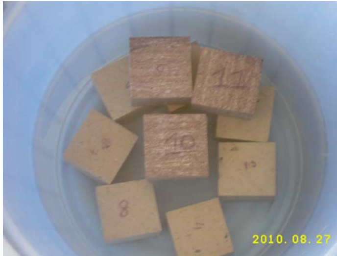
Şekil 4.4 Numunelere kapta su emdirilmesi
