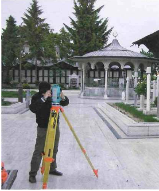
Şekil 2.3 Reflektörsüz Total Station ile yapılan ölçüm.( Kocadağıstan , 2008)
