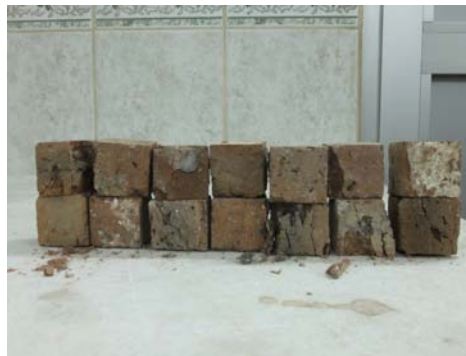
Şekil 4.17 Tuğla numunelerin kırıldıktan sonraki halleri
