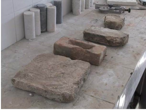
Şekil 4.12 Selçuklu,kırmızı ot ve sarı ot tuğlaları (sol baştaki Selçuklu dönemi tuğlasıdır.) (1,2,3,4 nolu deney numuneleri)
