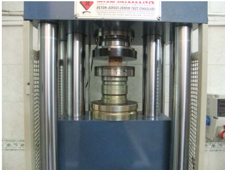
Şekil 4.6 Numunelerin serbest basınç aletine yerleştirilmesi
