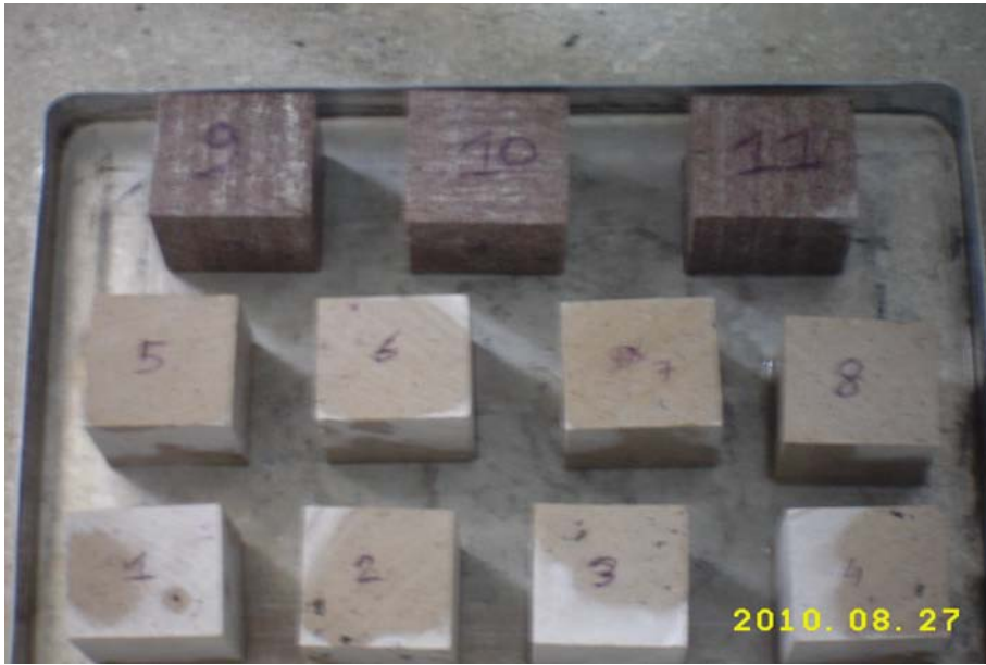
Şekil 3.1 7x7x7 cm boyutlarındaki küp numuneler
