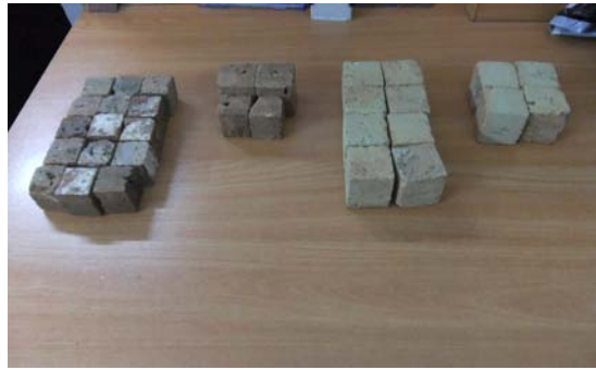
Şekil 4.15 Selçuklu ve Osmanlı dönemi Ot tuğlalarının deneye hazır hale getirilmesi (Sırasıyla 1,2,3,4 nolu deney numuneleri)
