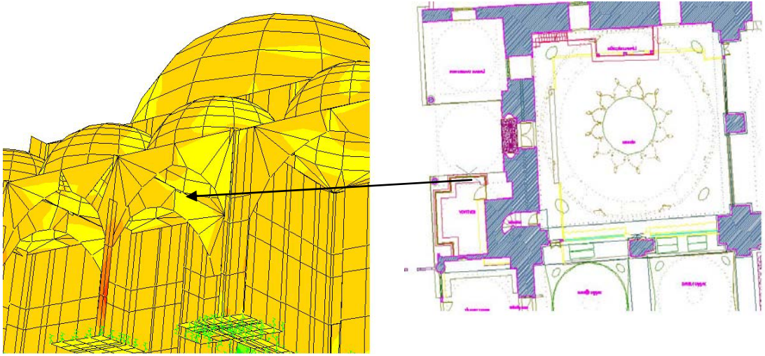
Şekil 5.6 Vestiyer-Giriş arası kemer çatlağı modelleme görünümü
