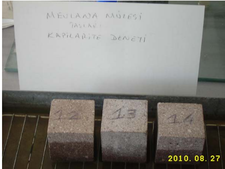
Şekil 4.1 Numunelerin kapiler su emme düzeneği
