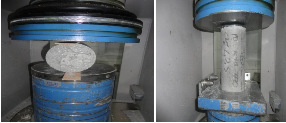
Şekil 3.16. Serbest basınç ve yarmada çekme dayanımı deneyleri
