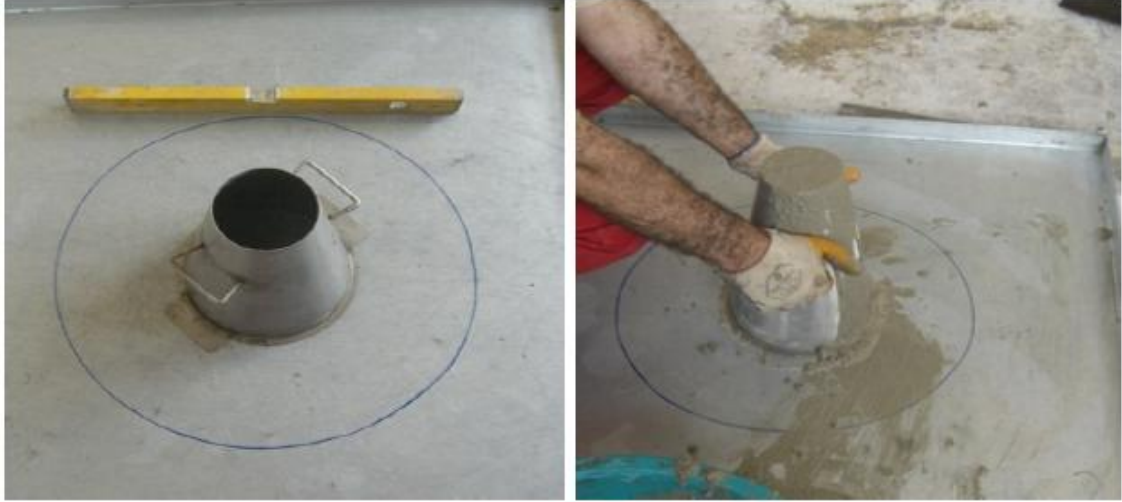
Şekil 3.10. Yayılma deneyinde kullanılan huni, 50 cm'lik çap işaretli tabla
