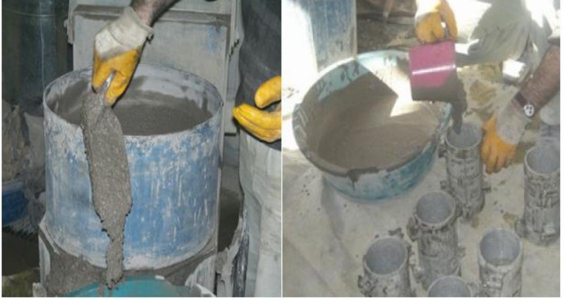
Şekil 3.6. Beton mikserinden numune alınması ve kalıpların KYHB ile doldurulması
