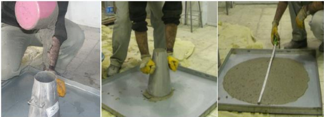
Şekil 3.8. Çökme sonrası yayılma deneyinin yapılması
