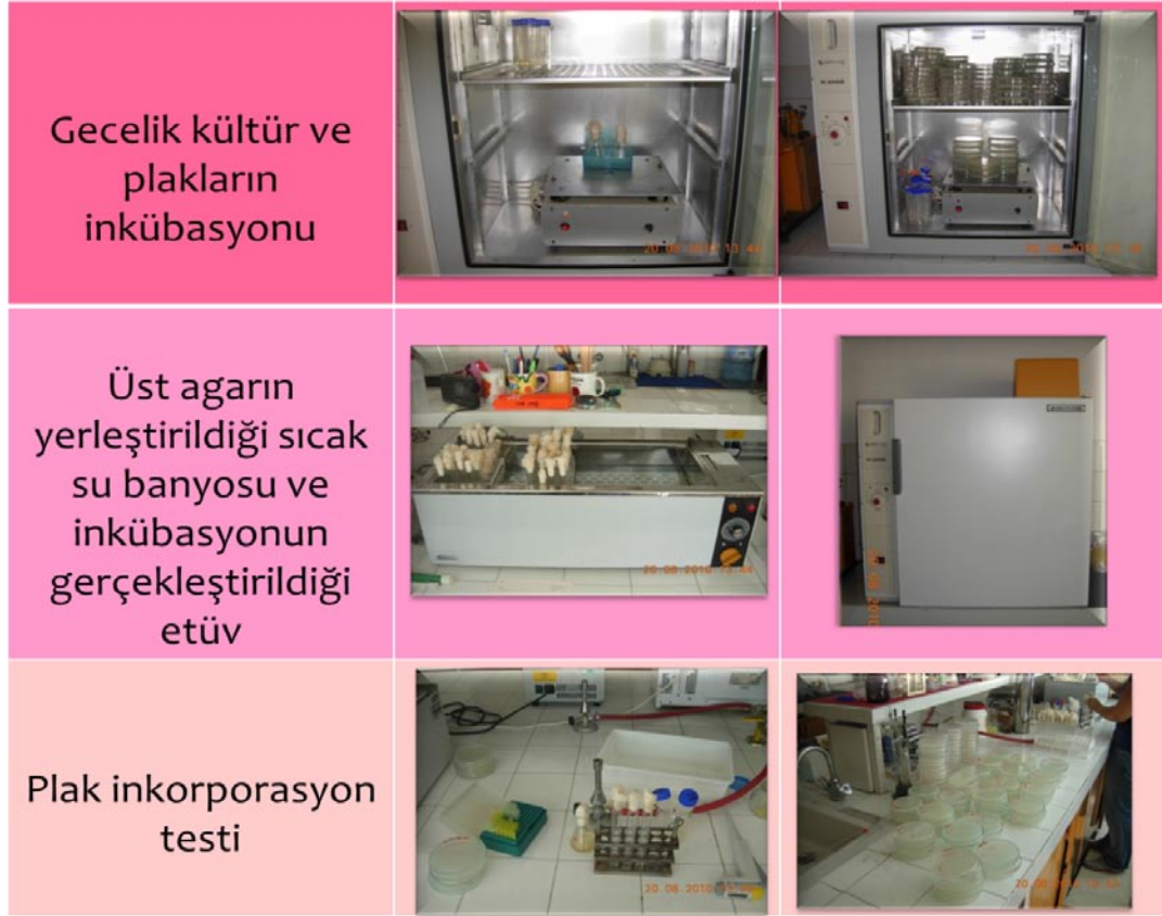
Şekil 3.3.1. Ames testi uygulaması
