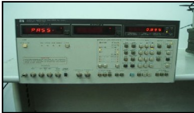
Şekil 3.1. Kapasitans –Voltaj ölçümleri için << 4192A 5MHz-13MHz LF Impedance Analyser>> kullanılan cihaz
