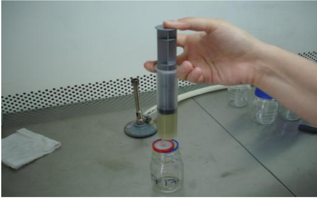
Şekil 3.6. A. alternata f.sp. citri 'nin Toksinlerinin Elde Edilmesi Sıvı Kültürün Soğuk Sterilizasyonu (0.22µ millipor filtre)
