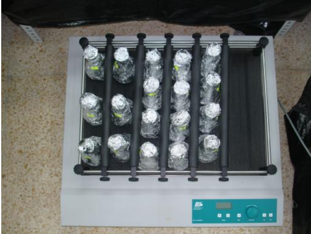
Şekil 3.5. A. alternata f.sp. citri 'nin Toksinlerinin Elde Edilmesi İçin Çalkalayıcıda Geliştirilen Sıvı Kültürlerden Bir Görünüm
