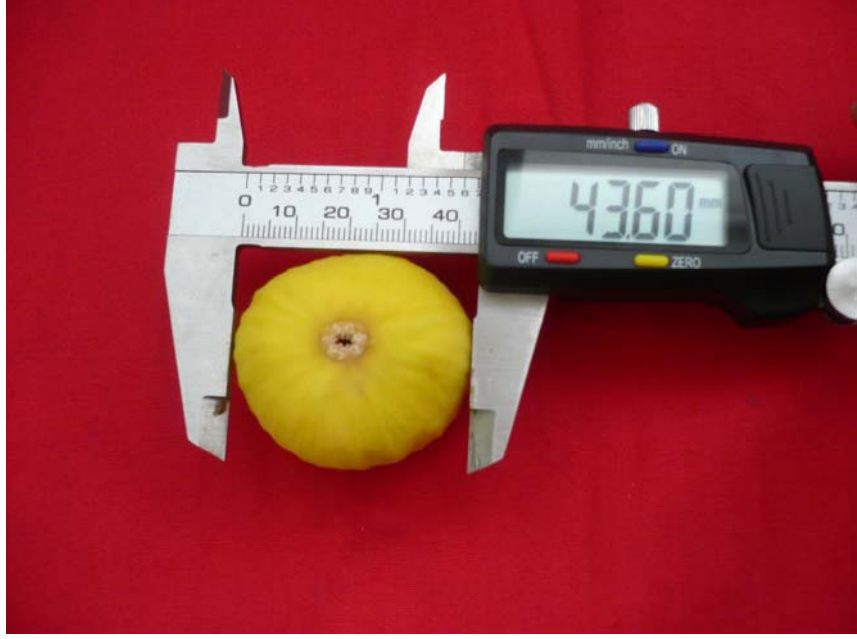
Şekil 3.8. Dijital kumpas ile meyve eni-boyu ölçümü
