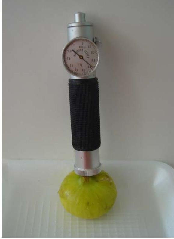
Şekil 3.9. Taze meyvede sertlik ölçümü
