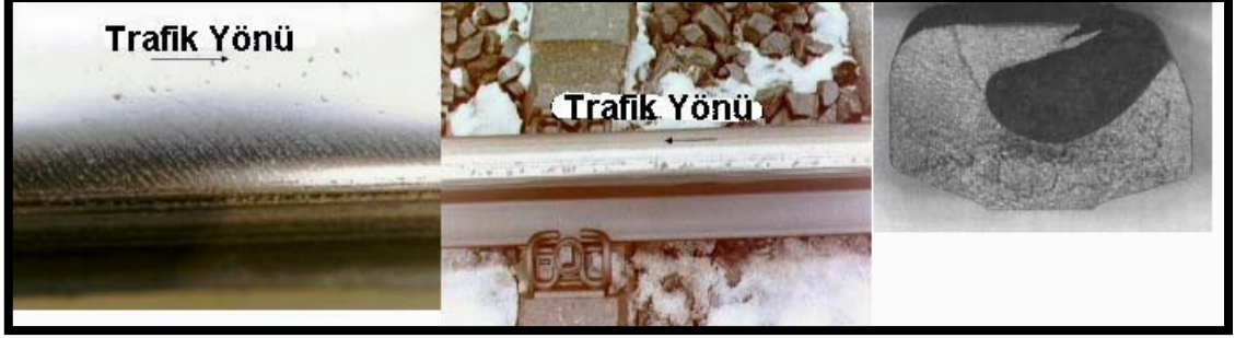
Şekil 1.27. Ray Yuvarlanma Temas Yüzeyinin Yorulması
