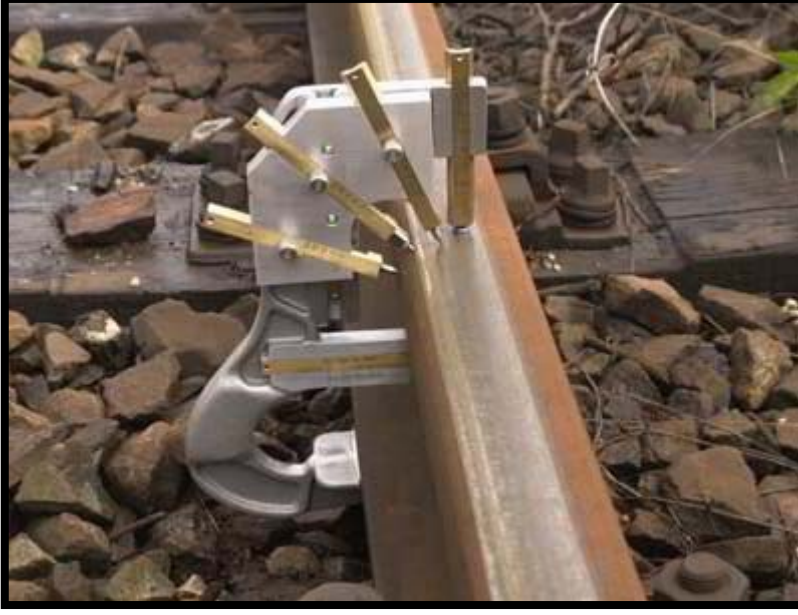
Şekil 1.31. Ray Aşınma Ölçüm Aleti
