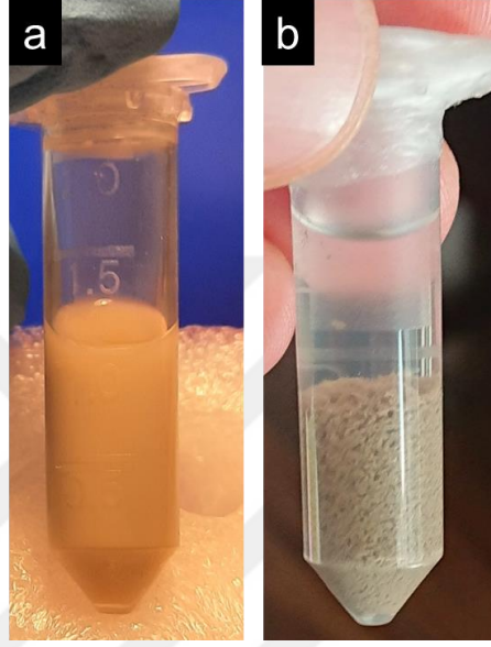
Şekil 4.36. ST-AgNT kompleksi (a) Etanol içerisinde dağılık halde bulunan AgNT dispersiyonu ve (b) ST karıştırıldıktan sonra etanol ile oluşan faz ayrımı görüntüleri.
