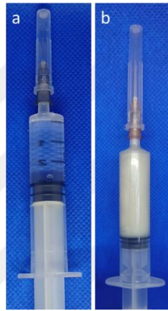
Şekil 3.3. Aseton içerisinde çözülmüş PCL ve PCL-AgNT çözeltileri.
