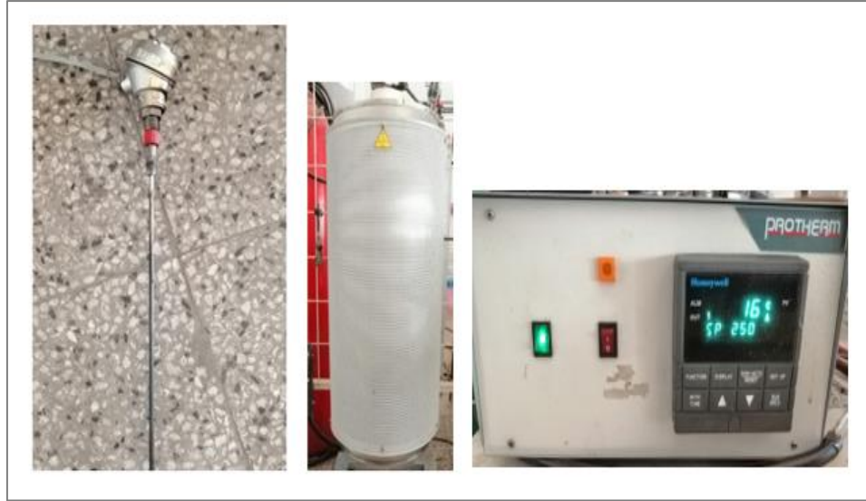
Resim 6.3. Isıl çift, dikey fırın ve sıcaklık kontrol cihazı
