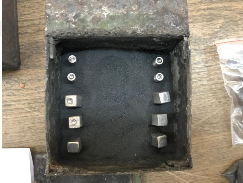
Şekil 4.6. 4340 numunelerinin Ekabor II tozu içerisine yerleşimi
