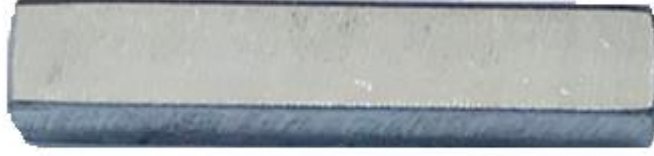
Şekil 4.5. Mikroyapı incelemeleri için işlenmiş parça
