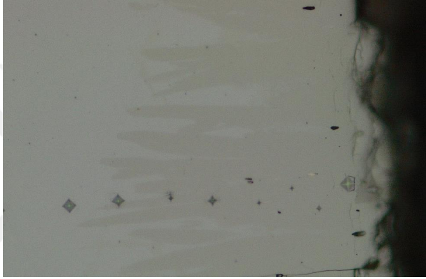
Şekil 5.7. 900°C'de 4 saat borlanan 34CrNiMo6 çeliğinin yüzeyinde oluşan sertlik izleri
