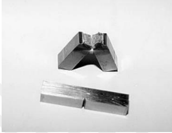
Şekil 3.6. Charpy V çentik deneyi için açılan V çentik ve darbe sonucu malzemenin görünümü
