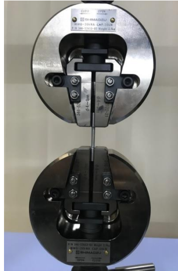
Şekil 4.9. Çekme numunelerinin çekme cihazı çenelerine bağlanması
