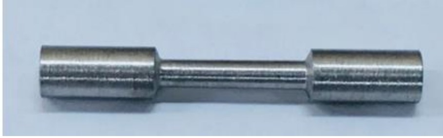
Şekil 4.2. ASTM E 8/E 8M – 08 standardına göre işlenmiş parça
