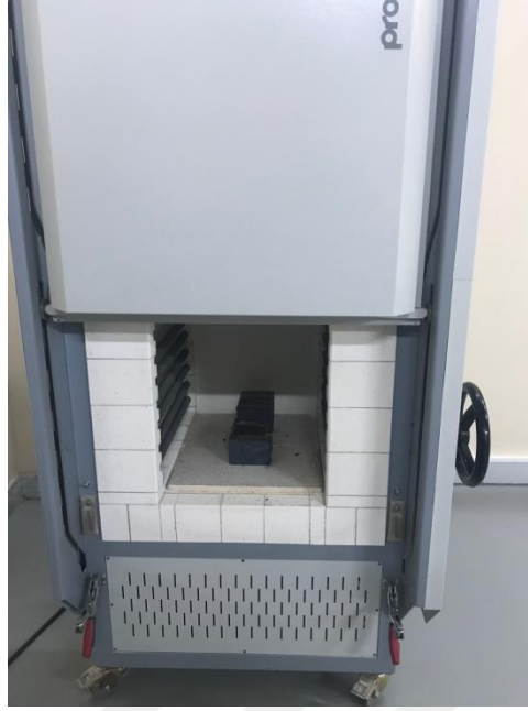
Şekil 4.7. Protherm HLF100 ısıtım fırını ve numunelerin yerleşimi
