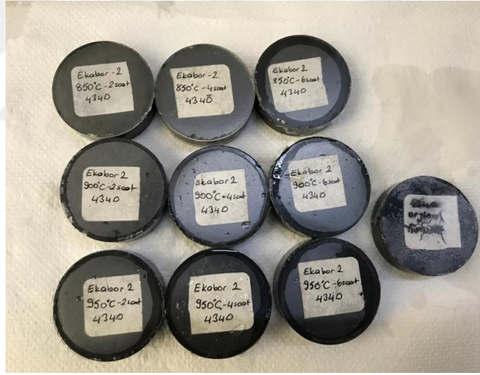
Şekil 4.14. Bakalite alma işlemi sonrası numuneler
