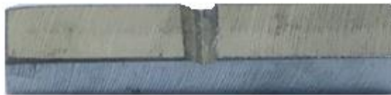
Şekil 4.4. ASTM E23 Charpy metal testi standardına göre işlenmiş parça
