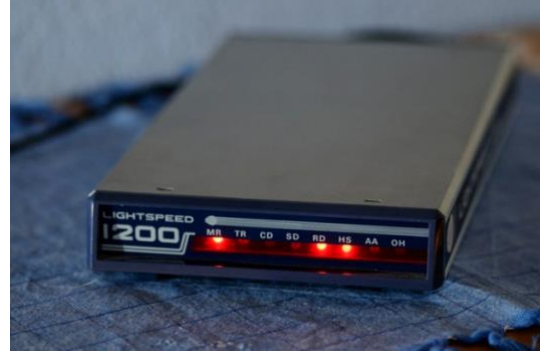
Görsel 1.5 1979'da, modem gelişimi dijital sinyallerin telefon hatları üzerinden iletilmesine, yaygın veri aktarımına ve nihayetinde internetin kullanılmasına izin verdi.
