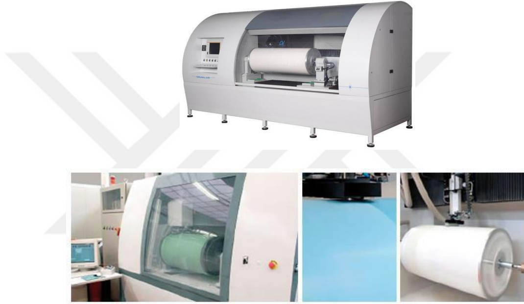
Görsel 4.20. Farklı tip ve özelliklerde rotatif eleğe desen işleyebilen lazer işleme makinesi Kaynak: Özkan, 2017, s.40
