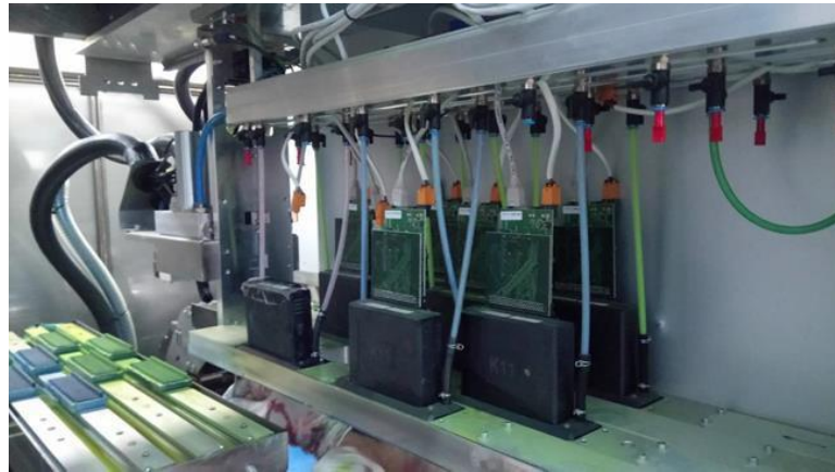
Görsel 4.32. Püskürtme kafalarının bar kafesinde yerleşimi Kaynak: Peker, 2020, s.28
