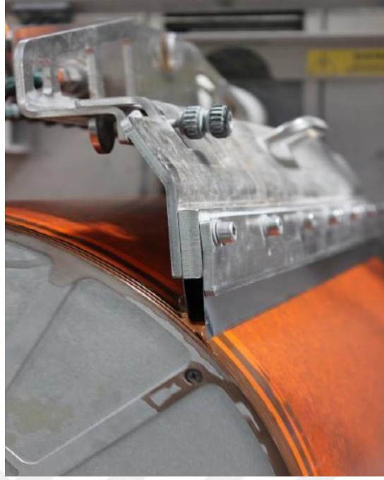
Görsel 4.21. Rotocolor elekte, baskı makinesinde bıçağın elek yüzeyindeki konumu Kaynak: Özkan, 2017, s.41
