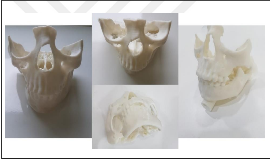
Şekil 4.8. FDM yöntemi kullanan 3B yazıcılarla imal edilen kişiye özgü modeller
