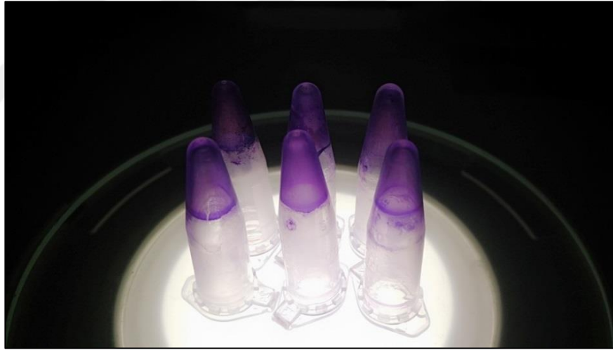
Şekil 4.19. Kristal viyole ile boyanma sonrası A. hydrophila suşlarının ependorfta biyofilm oluşumu
