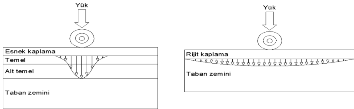
Şekil 1. Esnek ve rijit yol üstyapısı yük dağılımları
