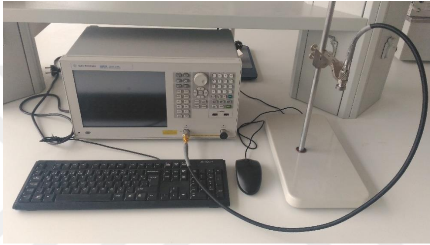
Şekil 3.7 Dielektrik özellikleri ölçmek amacıyla kullanılan ağ analiz sistemi
