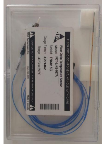
Şekil 3.3 (a) Fiso-UMI sıcaklık veri toplama sistemi ve (b) Fiber optik prob
