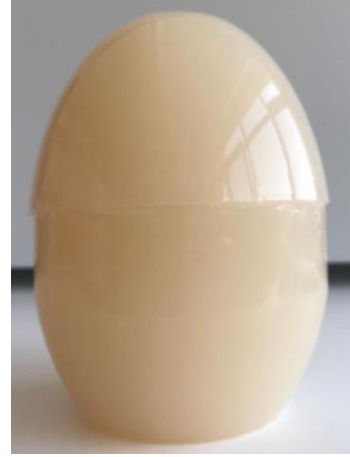
Şekil 3.2 Deneysel çalışmalar için hazırlanan %2 agar çözeltisinin şekil alması için kullanılan polipropilen kap (a), hazırlanan agar çözeltisinin katı formu (b)
