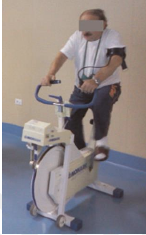
Resim 7: Bisiklet ergometresi ile ETT testi
