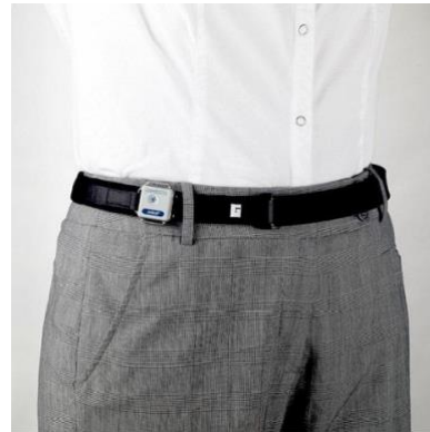
Resim 4: Aktikal cihazının bel bölgesinde kemer ile kullanımı
