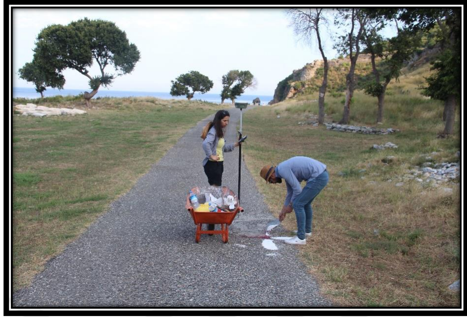
Şekil 8.13. Ölçümü yapılmış 15 numaralı noktanın işaretlenmesi
