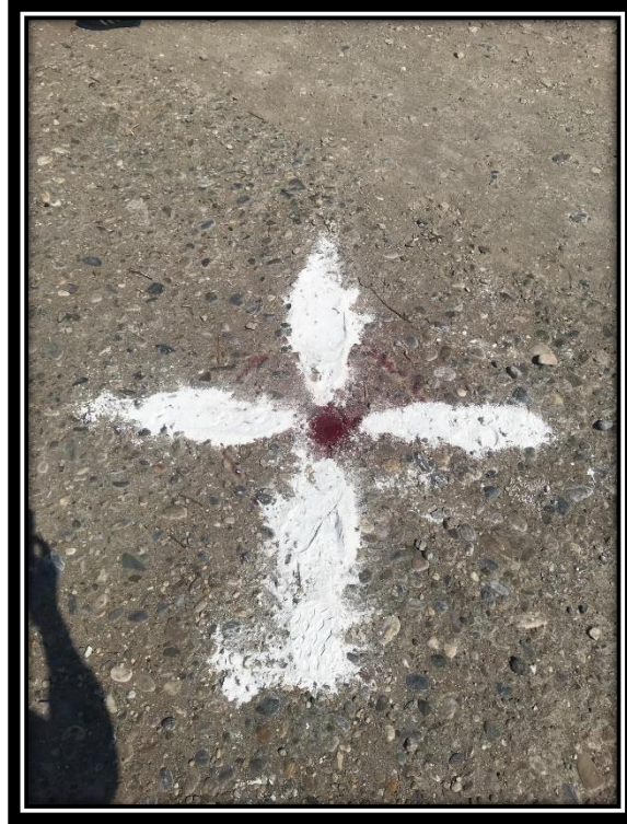
Şekil 8.2. Yer Kontrol Noktaları belirlemede kullanılan kireç ve sprey kullanım örneği
