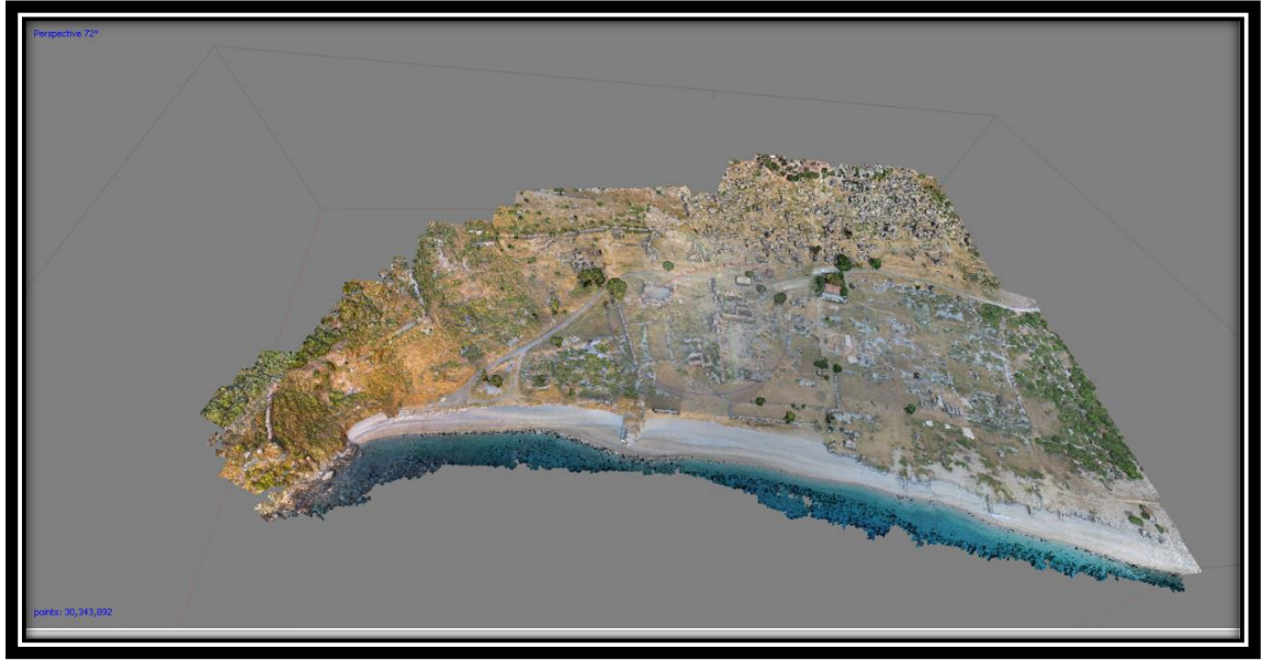
Şekil 8.22. Yoğun Nokta Bulutu (Dense Point Cloud)
