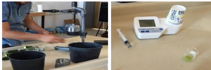
Şekil 3.13. Meyve suyunun çıkarılması ve dijital refraktometre ile SÇKM'nin ölçülmesi
