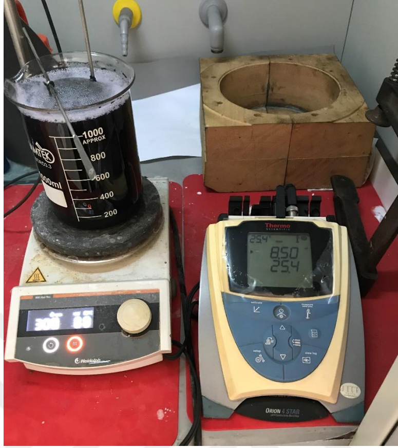
Şekil 5.2 : Akımsız Ni-B-GNPs kaplama banyo düzeneği.
