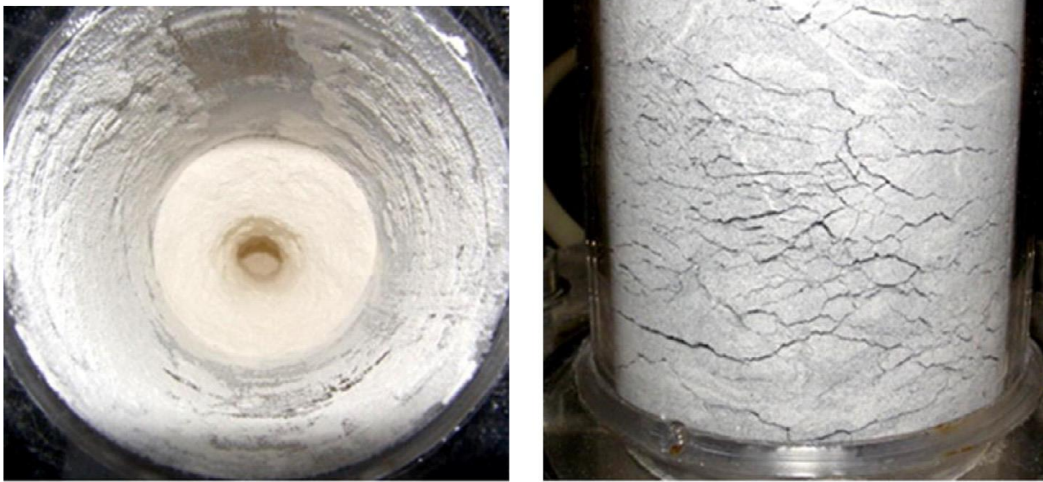
Şekil 3.2: Gaz kanalları (solda) ve Yatakta oluşan çatlaklar (sağda)
