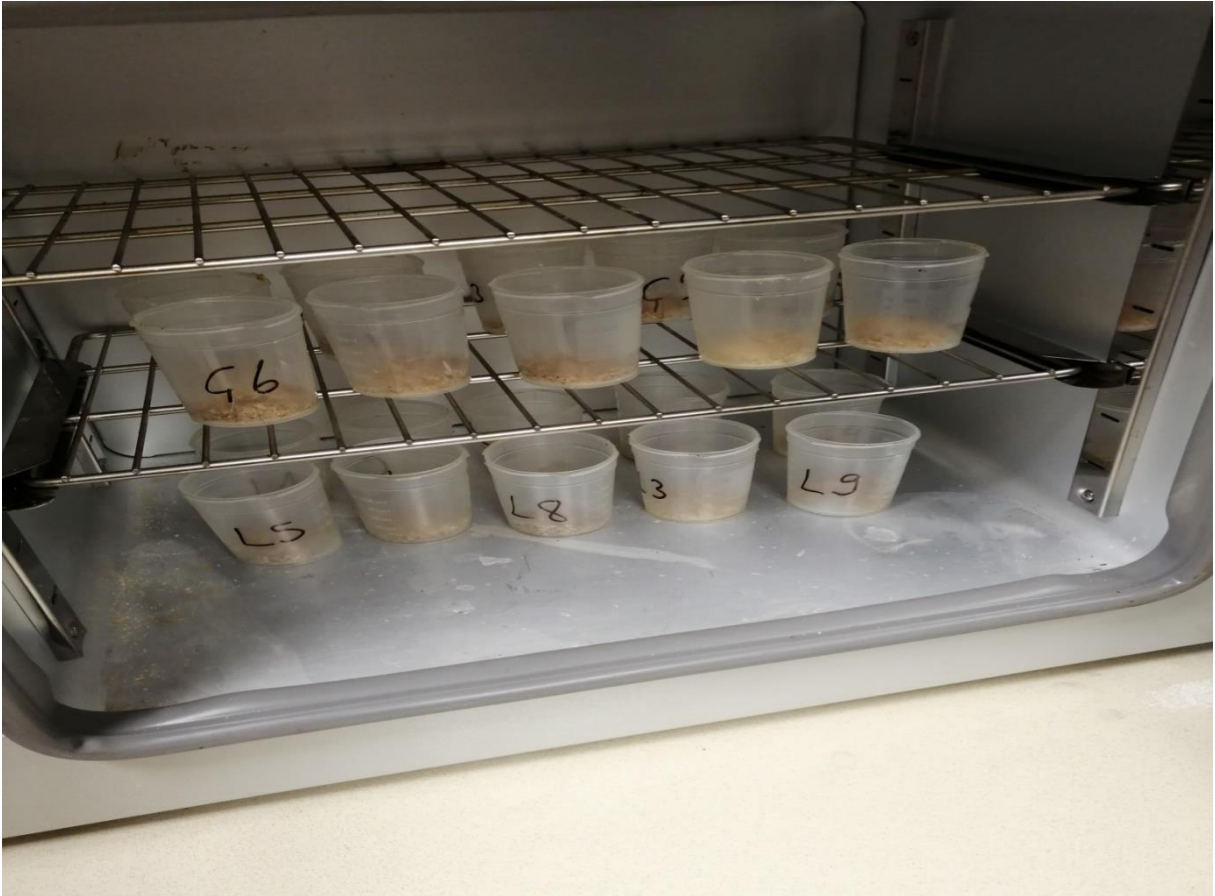
Şekil 17. Kalan Nemden Arındırmak İçin Tekrardan Kurutma İşlemi (Orjinal)
