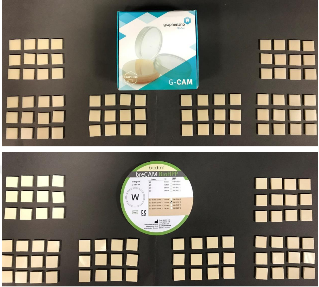
Şekil 2.3 Çalışmamızda kullanılan nano-grafen takviyeli PMMA ve PEEK disklerden hazırlanan bloklar
