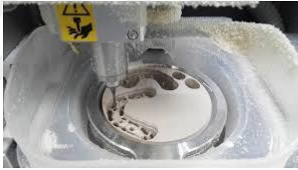
Şekil 1.7 CAD/CAM ile PEEK üretimi
