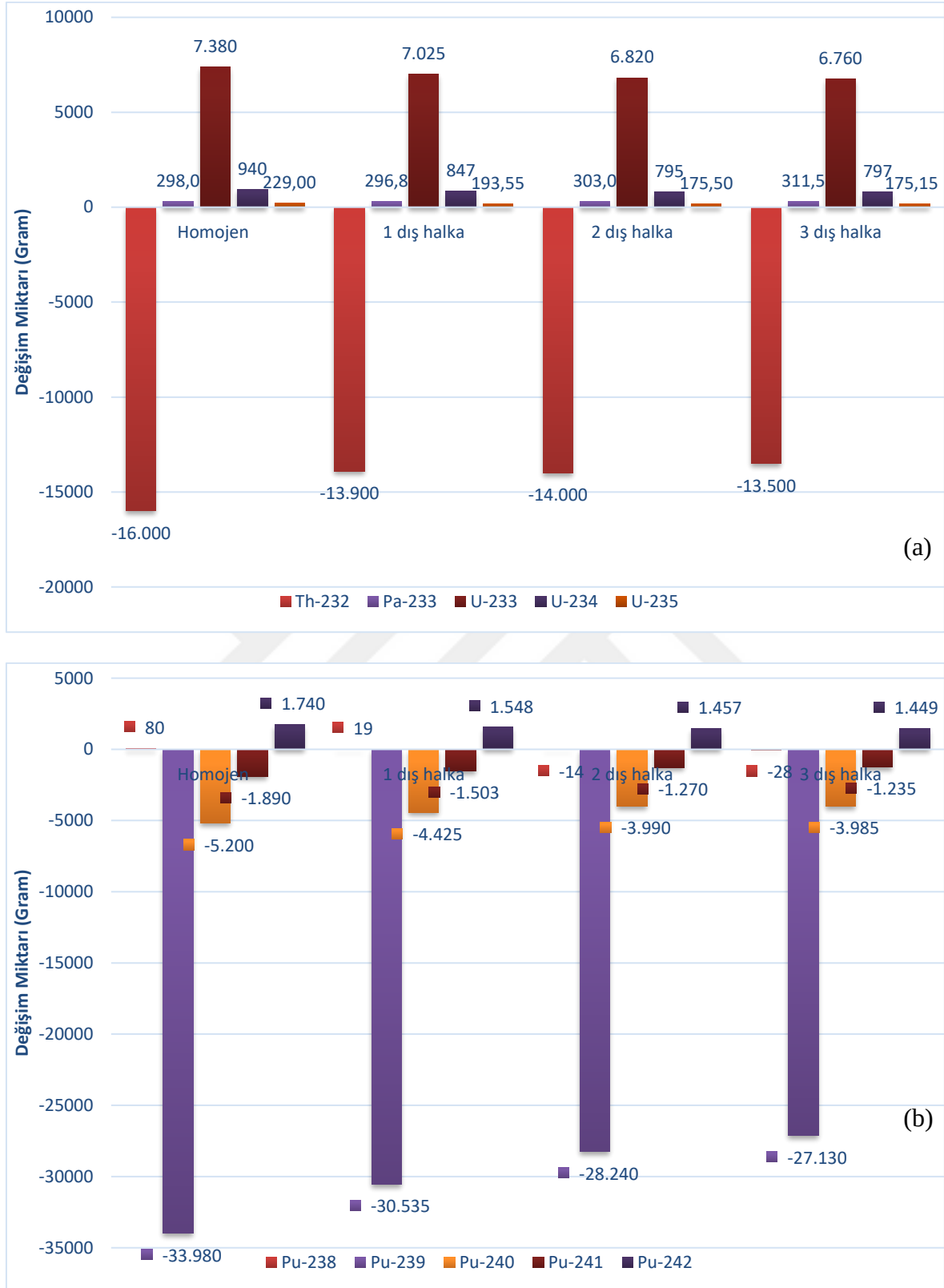
Şekil 6.16. Heterojen bir dizilime sahip ( \text{rgPuO}_2 + \text{ThO}_2 ) yakıt bileşimi için D12 işletme koşullarında Th-232, Pa-233, U-233, U-234, U-235 ve Plütinyum izotopların değişimleri
