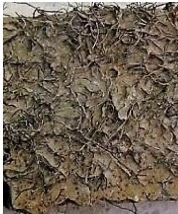
Şekil 4.33 : SIFCON içerisindeki süreksiz lifler.
