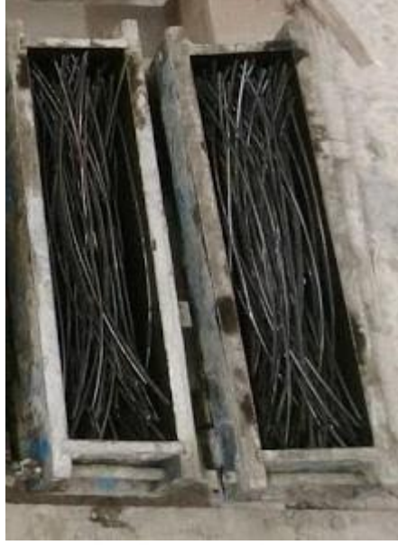
Şekil 3.26 : Sürekli liflerin dağılımı.
