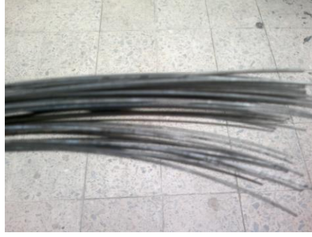
Şekil 3.20 : Atık kamyon/tır lastiklerinden elde edilen çelik teller.
