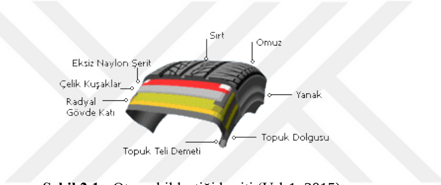
Şekil 2.1 : Otomobil lastiği kesiti (Url-1, 2015).
