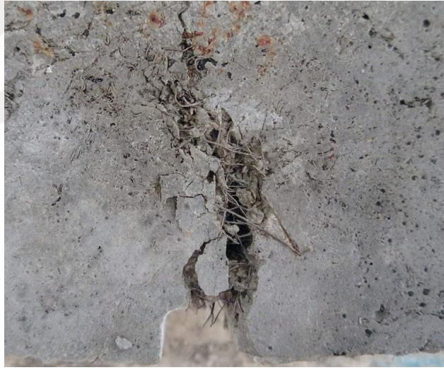
Şekil 4.42 : Çelik lifler ile tokluk artışının sağlanması.
