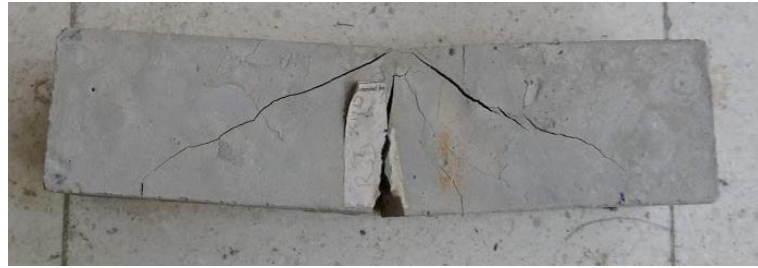
Şekil 4.35 : PÇ-%3D numunesinin kırılma şekli.
