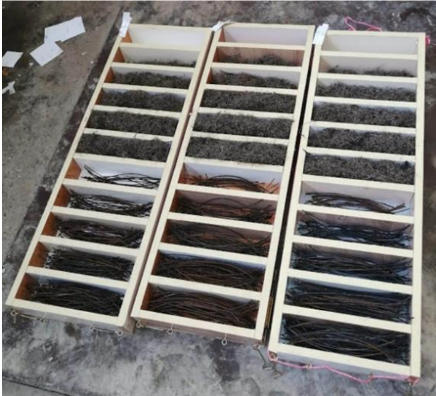
Şekil 3.25 : Dökümden önce çelik liflerin yerleştirilmesi.
