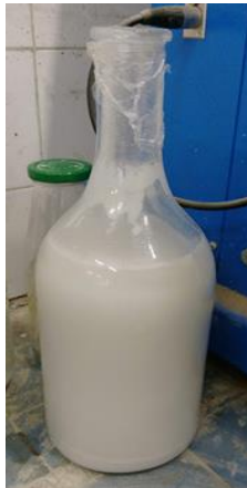
Şekil 3.30 : 14 M NaOH ve öğütülmüş atık cam ile hazırlanan aktivatör.
