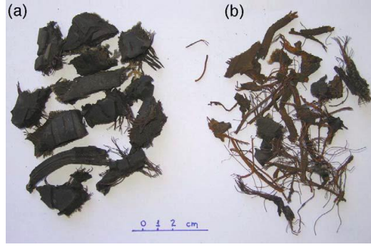
Şekil 2.2 : (a) Lastik parçası (b) Çelik tel (Papakonstantinou ve Tobolski, 2006).
