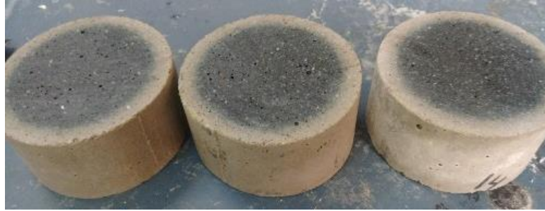
Şekil 3.1 : Hızlı klor geçirimliliği deneyi için kesilen harç numune.
