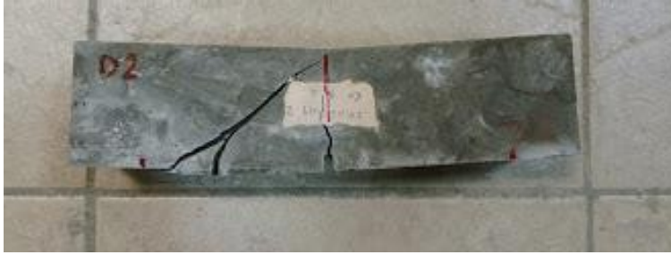
Şekil 4.29 : RD%2 numunesinin eğilme deneyi sonunda durumu.
