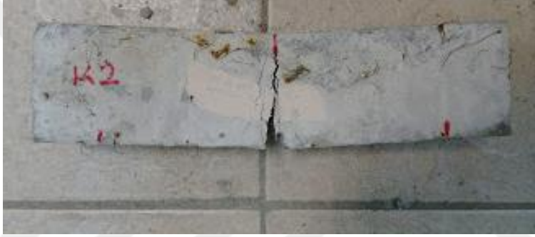
Şekil 4.28 : RK%2 numunesinin eğilme deneyi sonunda durumu.
