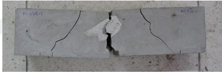
Şekil 4.34 : PÇ-%1D numunesinin kırılma şekli.
