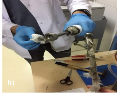
Şekil 3.13. a) Yalıtım seramiği ve elektrot, b) Elektrot bakımı
