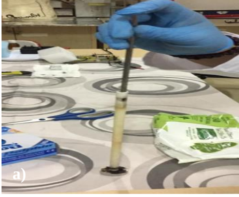
Şekil 3.13. a) Yalıtım seramiği ve elektrot, b) Elektrot bakımı
