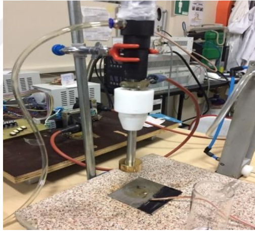
Şekil 3.12. Tasarım C plakalı ve altın elektrot tipi
