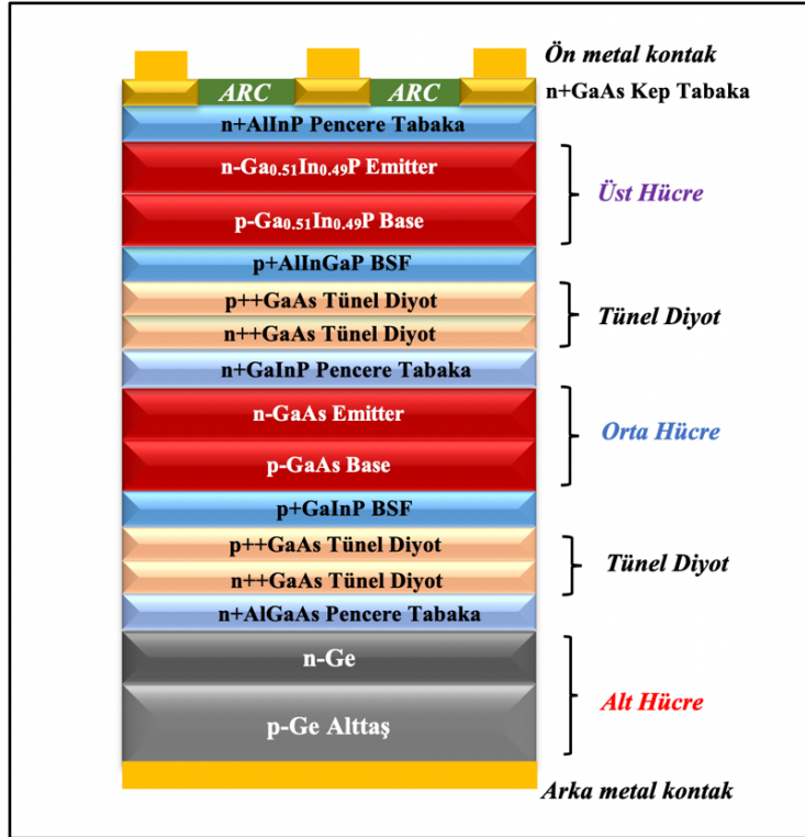
Şekil 3.13. Tipik bir üç eklemli güneş hücre yapısının tasarımı ve katmanları [40]
