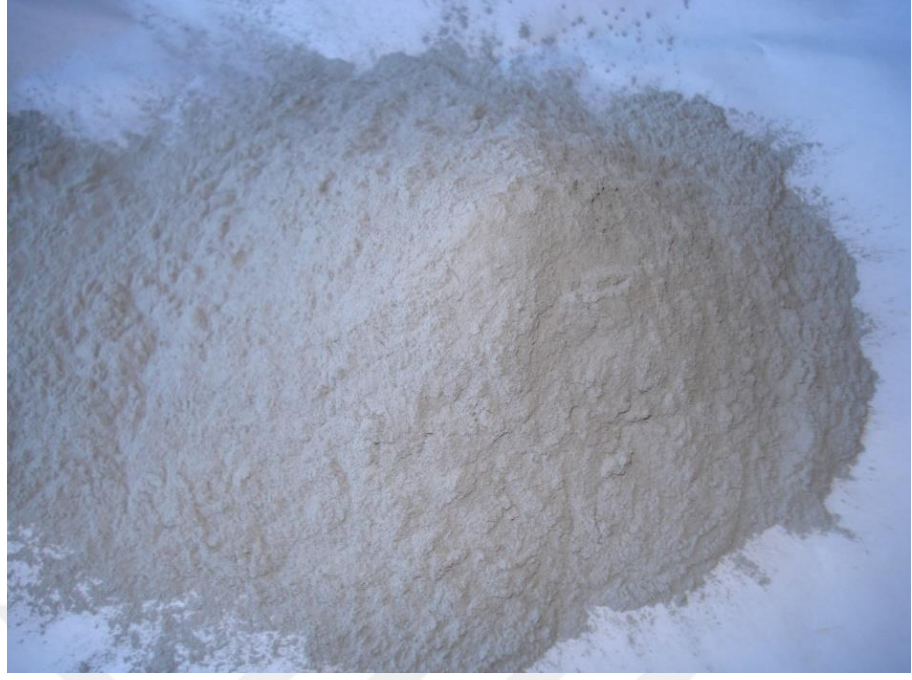
Şekil 3.2. Su atomizasyonu ile üretilmiş AA2024 alaşım tozu
