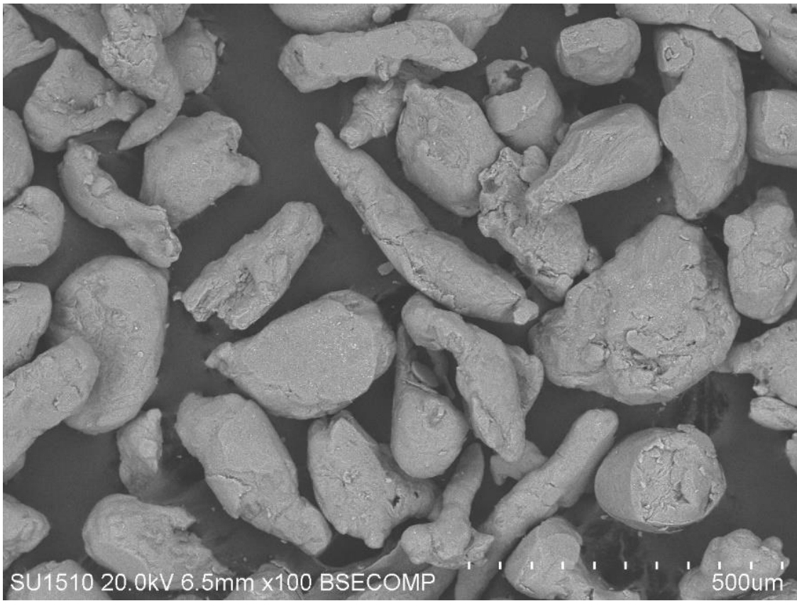
Şekil 4.1. Takviyesiz AA2024 tozlarının şekilsel yapıları; 100x (BSE) büyütme
