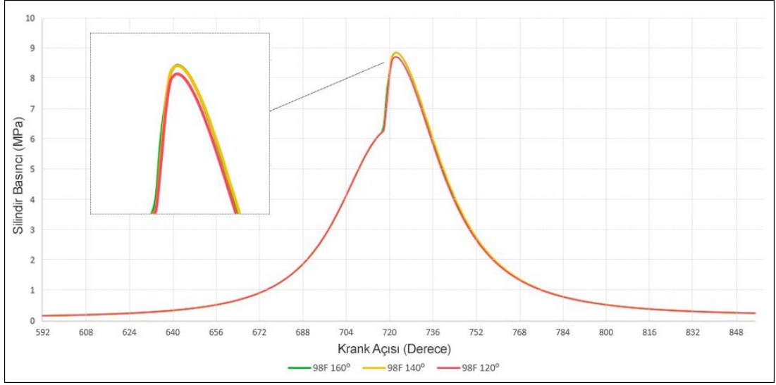
Şekil 6.20 Farklı püskürtme açılarındaki basınç değişimleri (98F)
