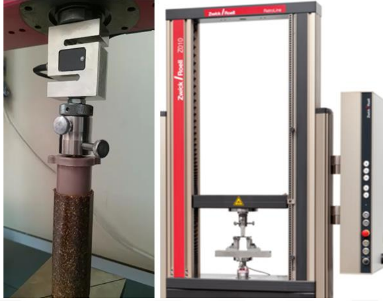
Şekil 4.23. Zwick/Roell Z010 Universal Test Makinesi ve basma deneyi testi
