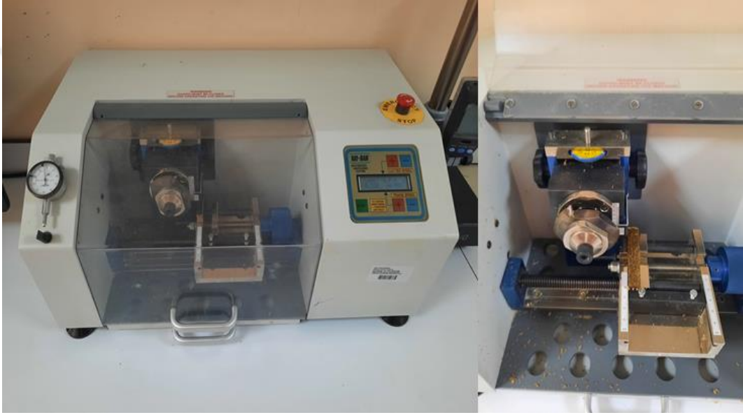
Şekil 3.17. Polytest RayRan™ çentik açma cihazı
