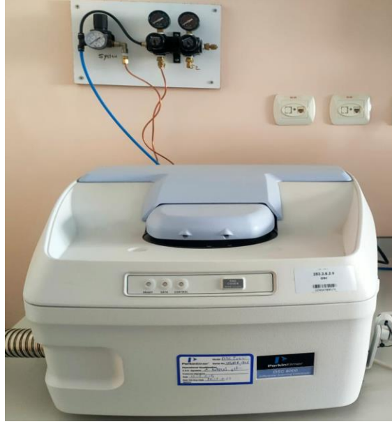
Şekil 3.23. PerkinElmer DSC–8000 diferansiyel taramalı kalorimetre cihazı
