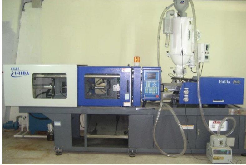
Şekil 3.13. Test örneklerinin üretildiği enjeksiyon kalıplama makinesi
