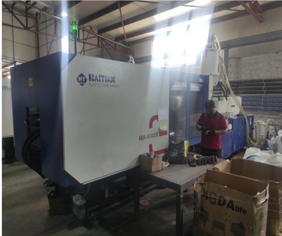
Şekil 3.14. Prototip mobilya destek ayaklarının üretildiği enjeksiyon kalıplama makinesi
