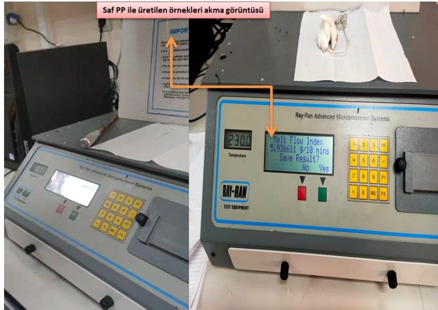
Şekil 4.16. Kontrol grubu saf PP ile üretilen örneklerde MFI analiz görüntüsü
