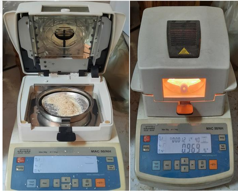
Şekil 3.10. Rutubet ölçme makinesi
