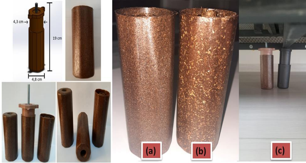
Şekil 3.9. Prototip mobilya destek ayağı görseli a) Dolgu maddesi atık talaş kullanılan ürün, b) Dolgu maddesi kenevir sapı kullanılan ürün ve c) Kanepede destek ayağı görüntüsü
