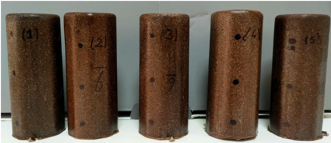
Şekil 4.21. Üretilen prototip mobilya destek ayakları kalınlık artış testine ait görüntü
