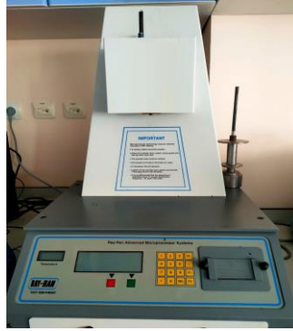
Şekil 3.25. Ray-Ran marka MFI cihazı
