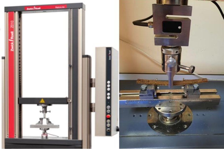
Şekil 3.16. Zwick/Roell Z010 Universal Test Makinesi ve eğilme deneyi testi
