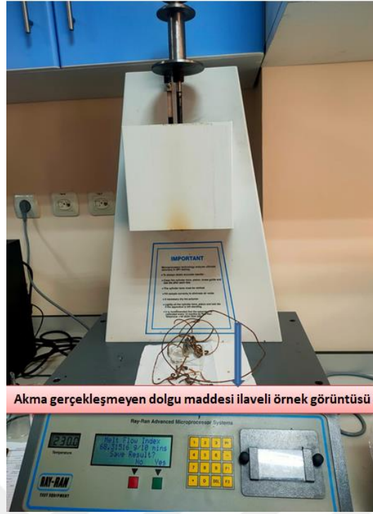
Şekil 4.17. Dolgu maddesi ilaveli örneklerde MFI analiz görüntüsü
