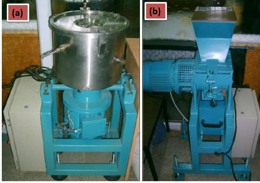
Şekil 3.11. Kompozit üretiminde kullanılan a) Karıştırıcı ve b) Kırıcı
