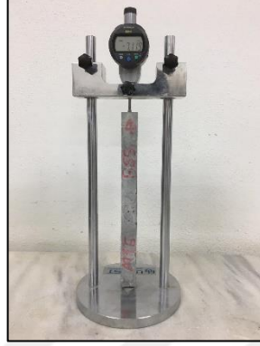
Şekil 3.3 Boy değişimlerinin belirlenmesinde kullanılan dijital komparatör
