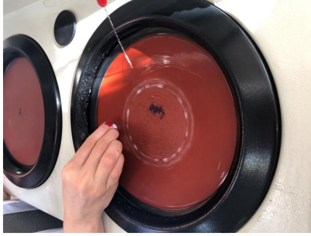
Şekil 2.2. Örnek yüzeylerinin zımparalanması
