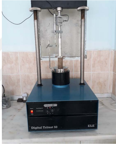
Şekil 3.16. Numunenin deney aletine yerleştirilmesi
