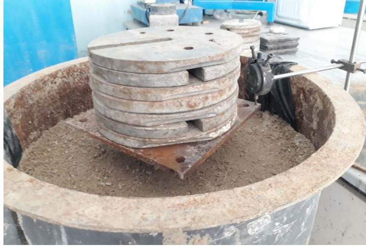
Şekil 3.48. Tank içerisindeki kolonun yüklenmesi
