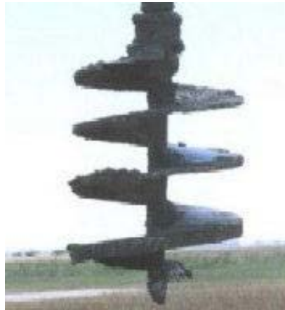
Şekil 2.3. Derin karıştırma yönteminde tek şaftlı burğu (Wahidy, 2019)
