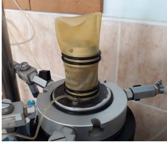
Şekil 3.22. Sızmanın engellenmesi için o-ring kullanılması
