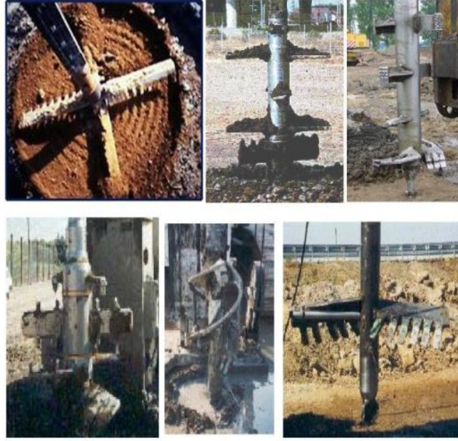
Şekil 2.4. Uygulamada kullanılan çeşitli şaftlar (Noori, 2019)
