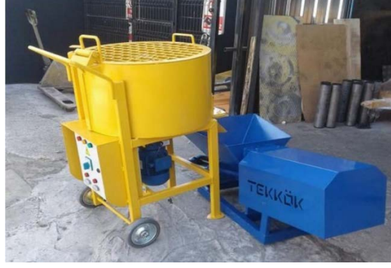
Şekil 3.37. Enjeksiyon karıştırma tankı ve pompası (Noori, 2019)
