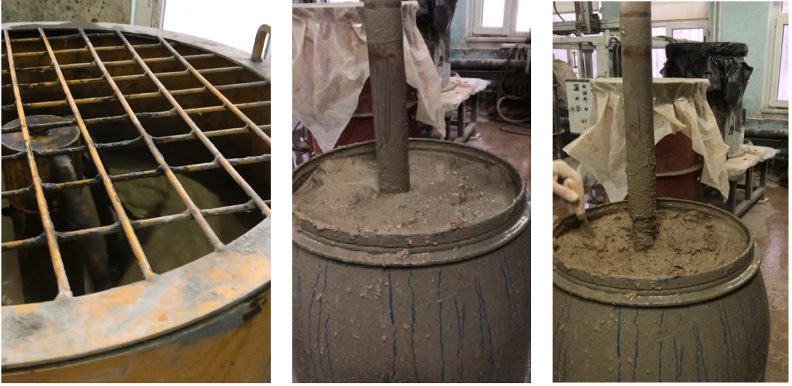
Şekil 3.45. Derin karıştırma kolonu imalatı (30 cm'lik kolon)
