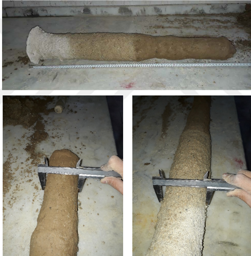
Şekil 3.49. 7 cm çapta imal edilen kolonun boy ve çapının ölçülmesi
