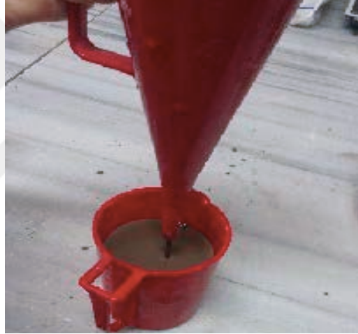
Şekil 3.10. Enjeksiyon karışımının Marsh Hunisinden tasa akıtılması
