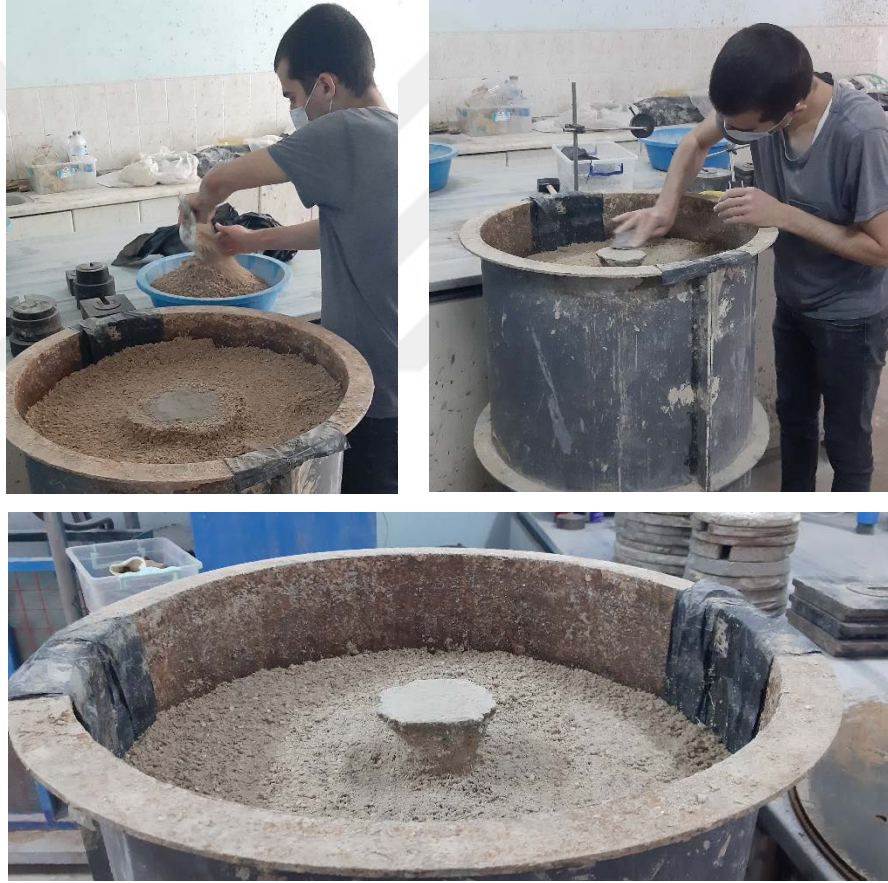
Şekil 3.47. Tank içerisindeki kolonun yüklenmeye hazırlanması
