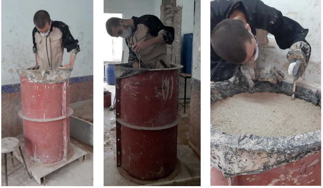
Şekil 3.40. Zeminlerin istenilen yüksekliklerde sıkıştırılma aşaması
