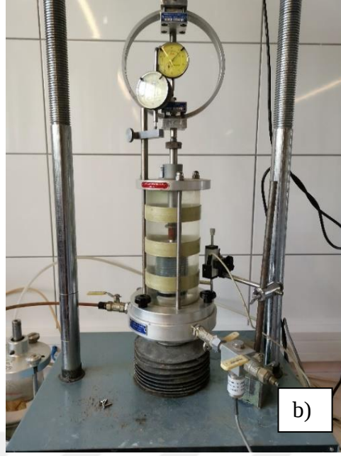
Şekil 4.16 : Haliç dip tarama çamurunun kimyasal katkılı GDT sonrası a) geotekstil tüp içerisinden çıkarılan örselenmemiş numune ve b) üç eksenli basınç deneyi cihazı.
