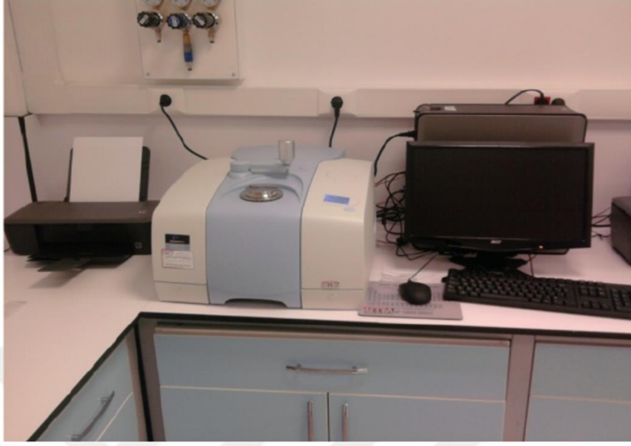
řekil 3.20 : Perkin Elmer - Spectrum 100 FTIR-ATR cihazı.
