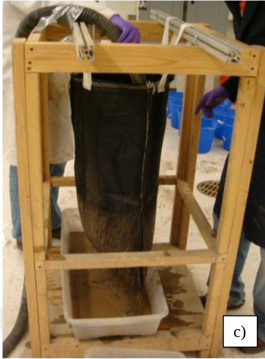
Şekil 2.14 (devam) : Susuzlaştırmada kullanılan deney düzenekleri a) FHT (Tencate, 2015); b)FHT/PFT (Grzelak, 2009), c) HBT (Grzelak, 2009), d) GDT (Tencate, 2007).
