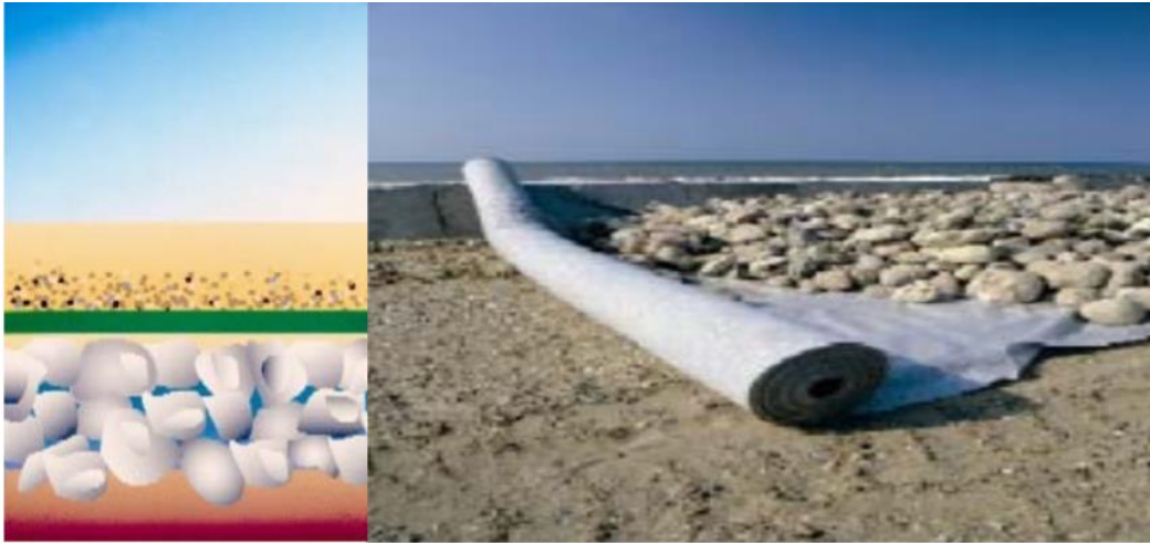
Şekil 2.3 : Geotekstilin ayırma amacıyla kullanımı (Koerner, 2016).
