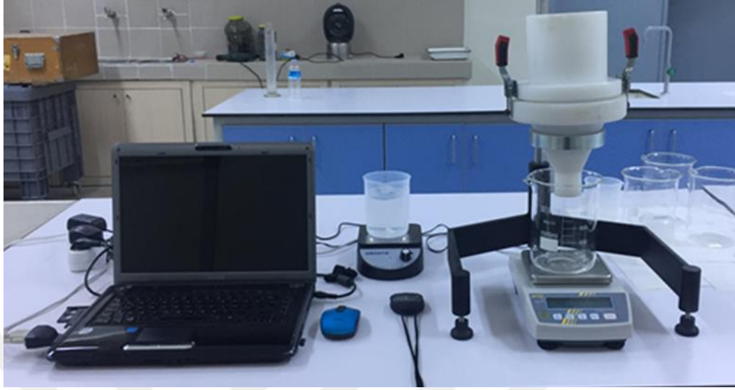
Şekil 3.16 : Hızlı Susuzlaştırma Deney (RDT) düzeneği.
