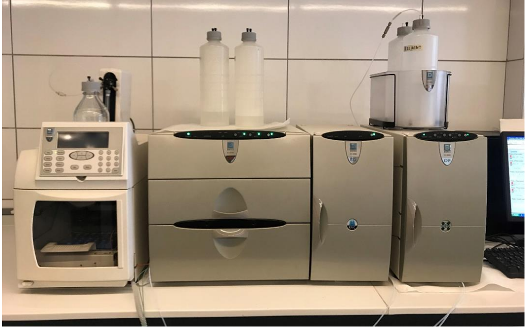
řekil 3.21 : IC, Dionex ICS-3000 cihazı.
