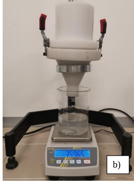
Şekil 4.34 : RDT sonunda oluşan a) filtre kek ve b) sızıntı suyu görüntüleri.
