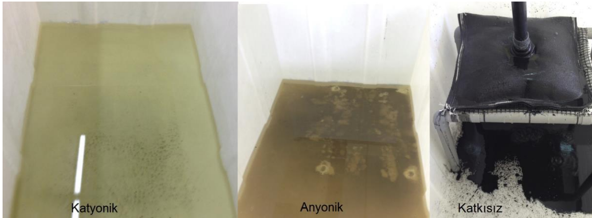
Şekil 2.15 : GDT Deneyleri sırasında torba dışına sızan suyun görünümü (Turan ve diğ, 2014).
