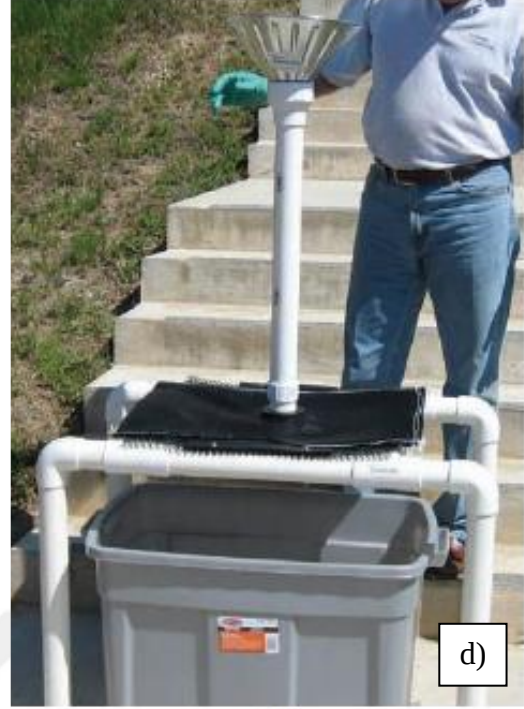
Şekil 2.14 (devam) : Susuzlaştırmada kullanılan deney düzenekleri a) FHT (Tencate, 2015); b)FHT/PFT (Grzelak, 2009), c) HBT (Grzelak, 2009), d) GDT (Tencate, 2007).
