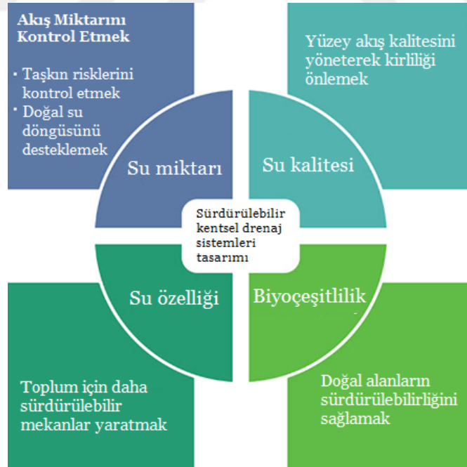
Şekil 2.6. Sürdürülebilir drenaj sistemleri tasarımı unsurları (Woods Ballard vd., 2015’den uyarlanmıştır).
