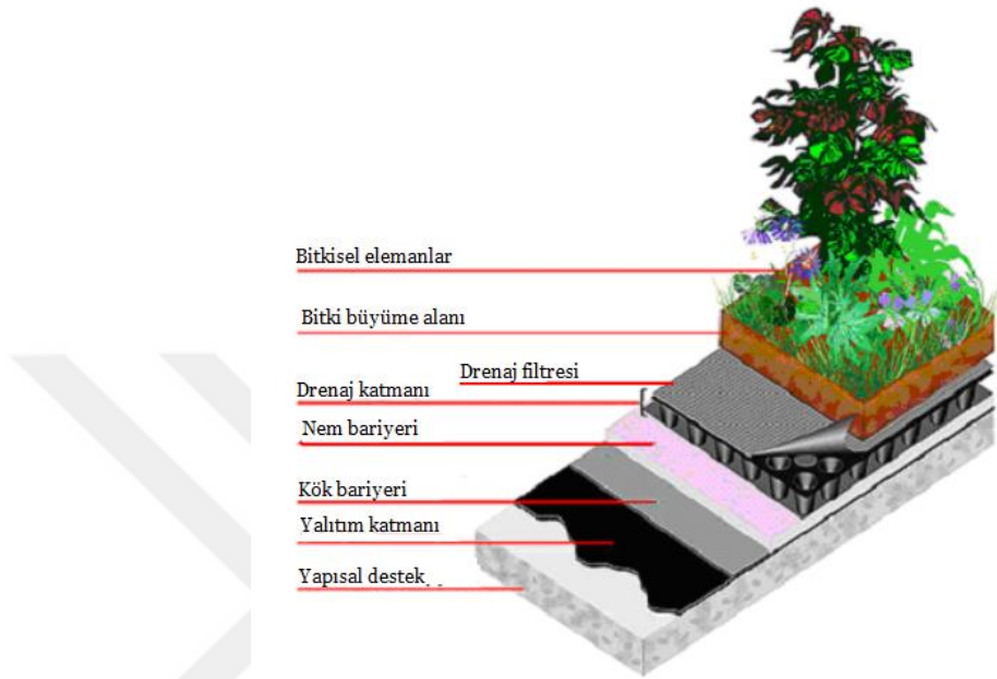
Şekil 4.17. Yeşil çatı katmanları (The City of Edmonton, 2014’den uyarlanmıştır).
