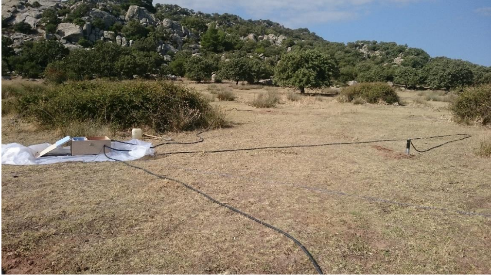
Şekil 1.19 : Kayıt almaya hazır ölçü düzeneği. Tüm kablo bağlantıları yapıldıktan sonra alıcı ünitesi (solda) kaydedicisi ile birlikte elektrik ve manyetik alan zaman serisini örneklemektedir. Düşey manyetik alan bobini (sağda) alıcı ünitesinden en az 20 m uzakta olmalıdır.
