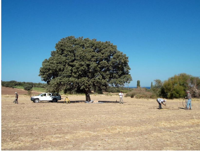
Şekil 1.14 : Kayıttan önce elektrotlar ve bobinler için gerekli kabloların birbirlerinden uzak bir şekilde serimi gerçekleştirilmektedir.
