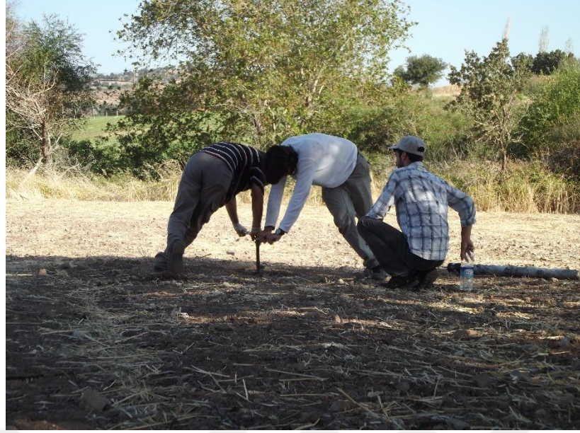
Şekil 1.15 : Manyetik alan için düşey bobinin bir kuyu açılarak gömülmesi ile ölçümlerdeki gürültü seviyesini en aza indirmek mümkün olmaktadır.
