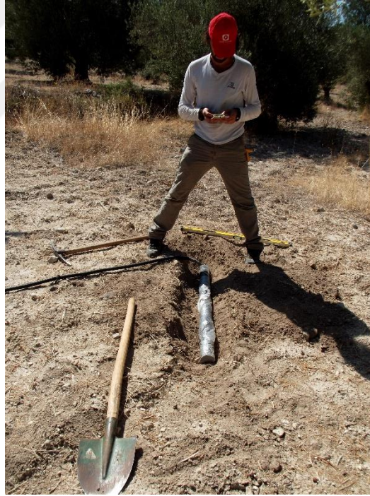
Şekil 1.16 : Yatay manyetik alan bileşenleri için bobinler K-G ve D-B doğrultusunda, toprağın yaklaşık 15-20 cm derine gömülmektedir. Herhangi bir olası sarsıntıya karşı bobinin yanları ve üstü toprakla iyice örtülmektedir.
