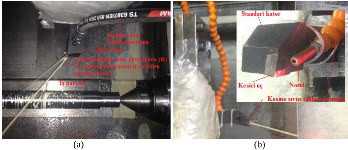
Resim 4.3. Kesme sıvısı uygulaması a) talaş yüzeyinden ve serbest yüzeyden (R+F) soğutma b) talaş yüzeyinden (R) soğutma
