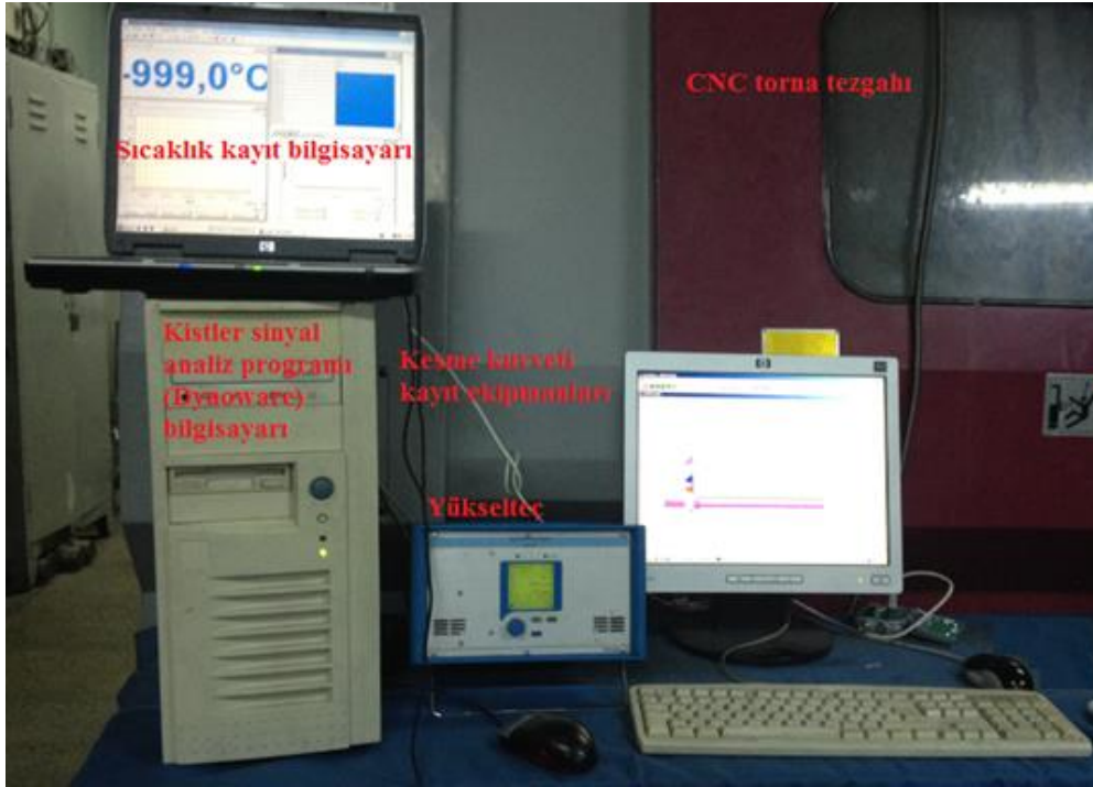
Resim 4.9. Kesme kuvveti ve sıcaklık kayıt sistemi
