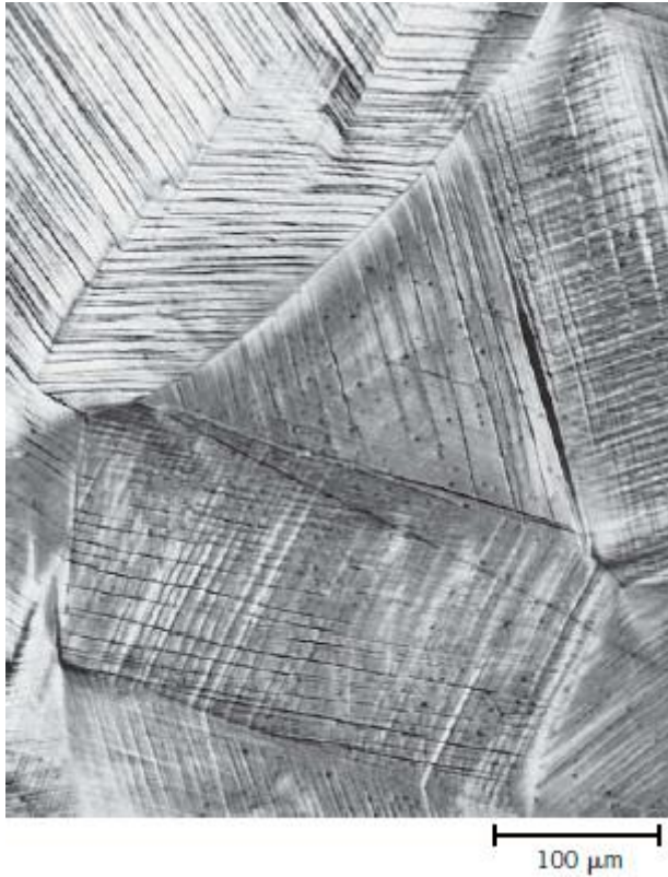
Şekil 3.26. Çok kristalli bakırda deformasyon sonrası oluşan kayma çizgileri (bantları) [243]
