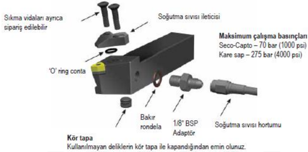
Şekil 4.6. Jet kater ve parçaları [301]
