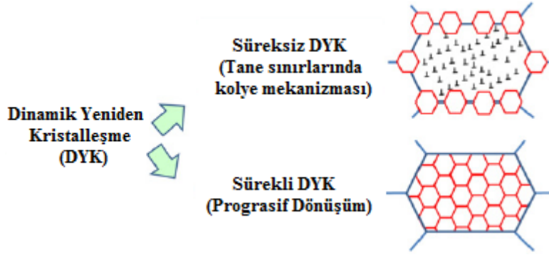
Şekil 3.41. Dinamik yeniden kristalleşme tiplerinin şematik gösterimi [227]
