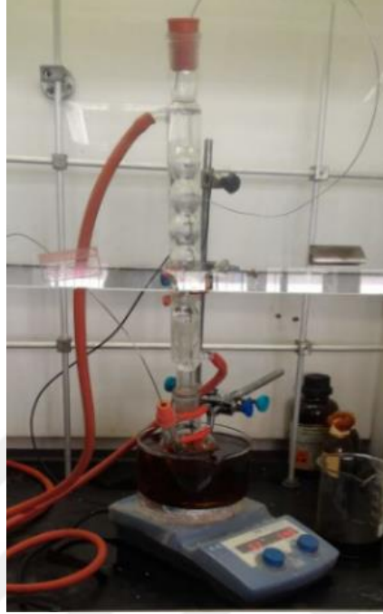
Şekil 2.4. McMurry tepkimesinin düzeni
