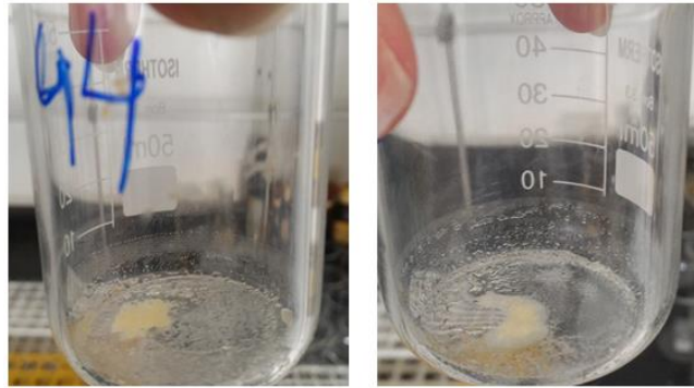
Şekil 3.5. McMurry sonrası yapılan kolon kromatografisi sonrası saflaştırılmış olarak elde edilen BSP-2 maddesi
