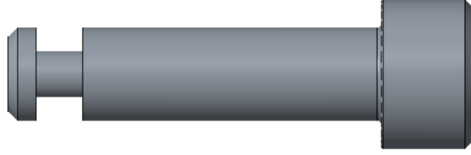
Şekil 4.12. M10 sıkıştırma cıvatası
