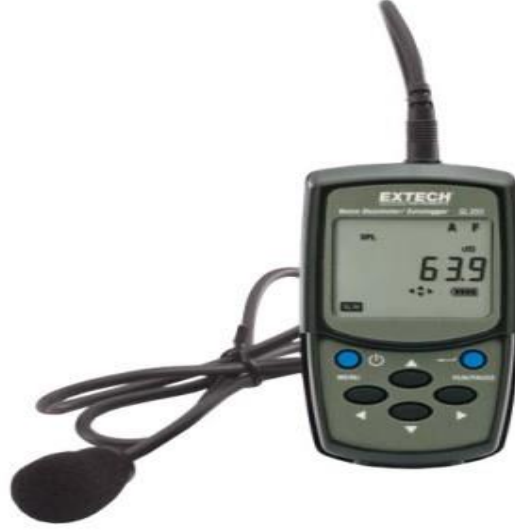
Şekil 4.5. Kişisel maruziyet gürültü ölçüm cihazı
