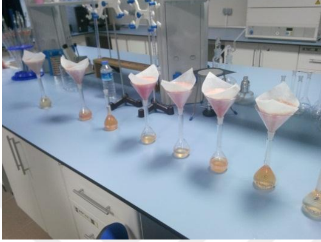
Şekil 3.13. Domates meyve pulpunda meyve suyu süzülme aşaması.
