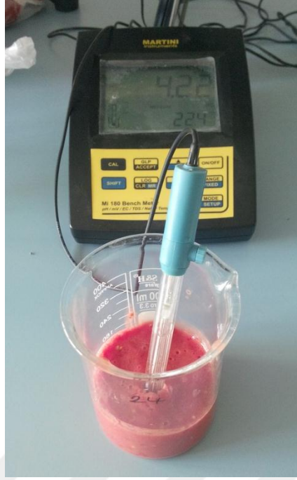
Şekil 3.14. Domates pulpunda pH ölçümü.
