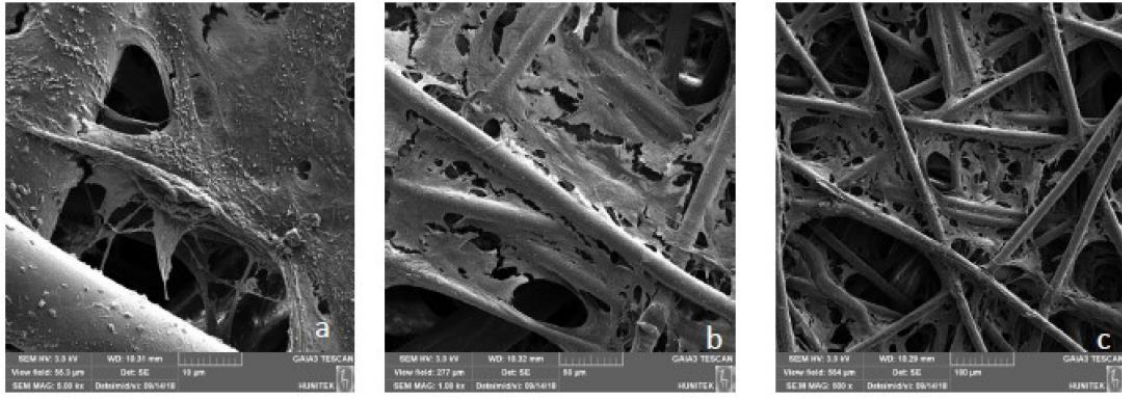
Şekil 4.16 Grup 1- H_2SO_4(+) örneğine ait SEM görüntüsü (11.gün): a) 5000x, b) 1000x, c) 500x büyütme
